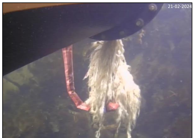
Figur 21: Lastestroppen sertifisert for løft på maksimalt fem tonn med slitasjeskade. Foto: Skarholm Dykking og Ingeniørtjenester AS
