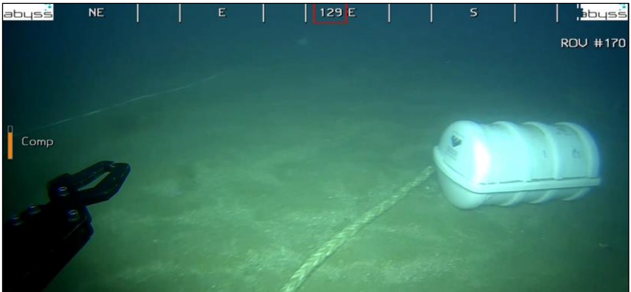
Figur 22: En redningsflåte ble ikke utløst og ble med fartøyet ned. Foto: Abyss
