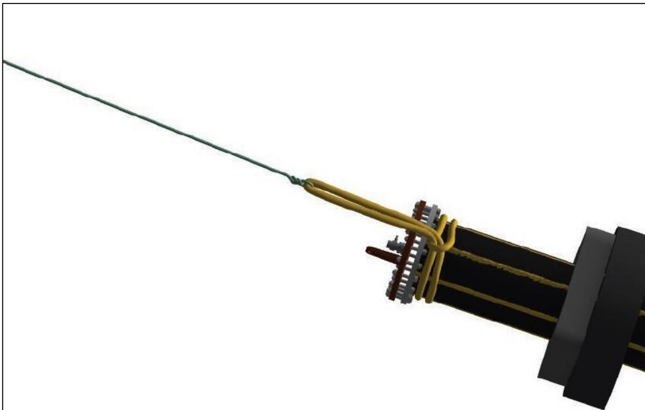
Figur 2: Rundsling, sertifisert for løft på maksimalt tre tonn, festet til rørslepet i den enden som hadde PVC-hjul montert. Illustrasjon: SHK
