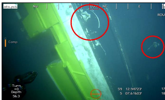
Figur 13: To av tre punkteringsskader i styrbord skrog. Foto: Abyss
