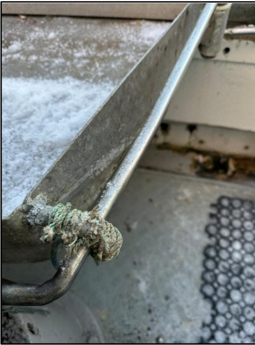
Figur 8: Nødstopstaget uten trekile. Foto: SHK
