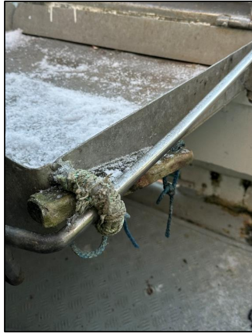
Figur 9: Nødstopstaget med trekile. Foto: SHK
