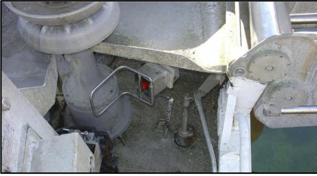
Figur 10: Garnspillet og nødstoppanordningen. Foto: SHK
