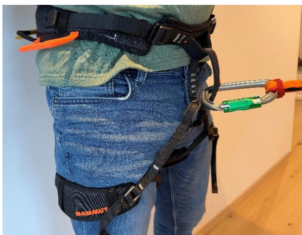
Figur 17: Riktig innfesting av twistlock-karabin. Foto: SHK
