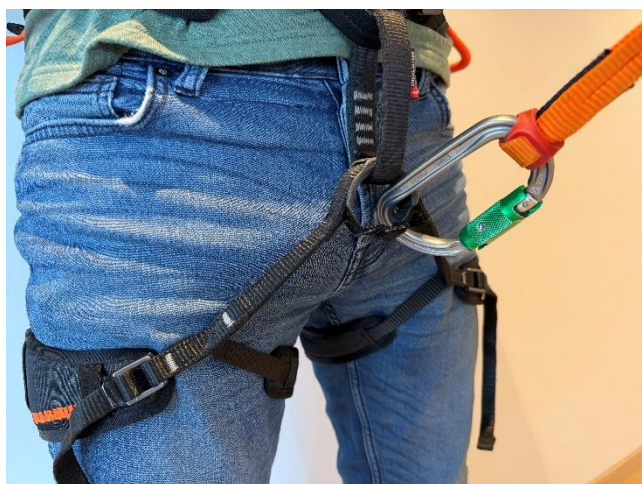
Figur 16: Feil innfesting av twistlock-karabin. Foto: SHK
