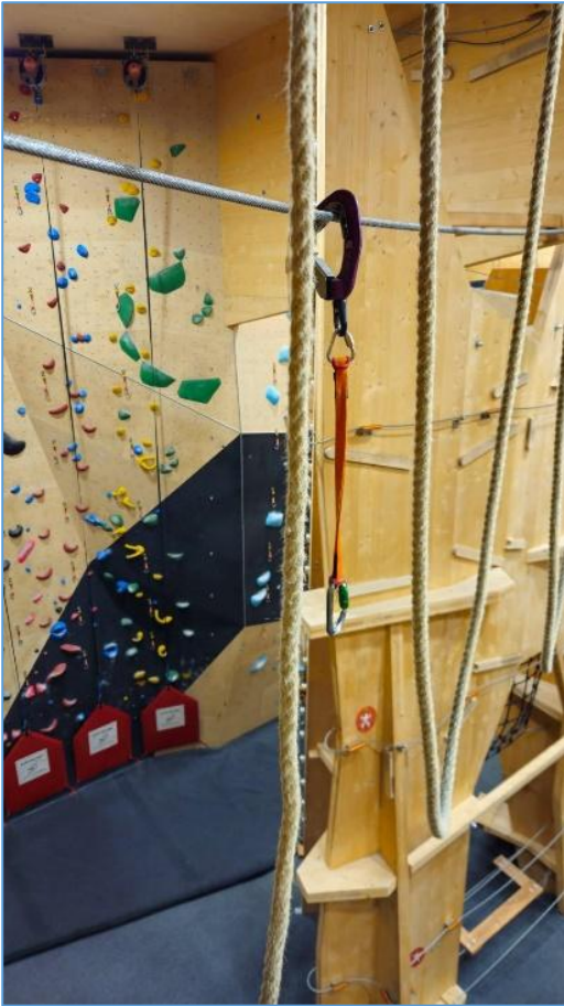
Figur 1: Sikrings Slyngen slik den ble funnet etter ulykken. Foto: Høyt Under Taket Moss AS
