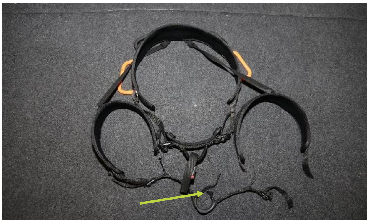
Figur 11: Klatreselen gutten brukte ved ulykken. Åpen spenne på tverrbåndet er markert. Foto: Politiet, med påtegning av SHK
