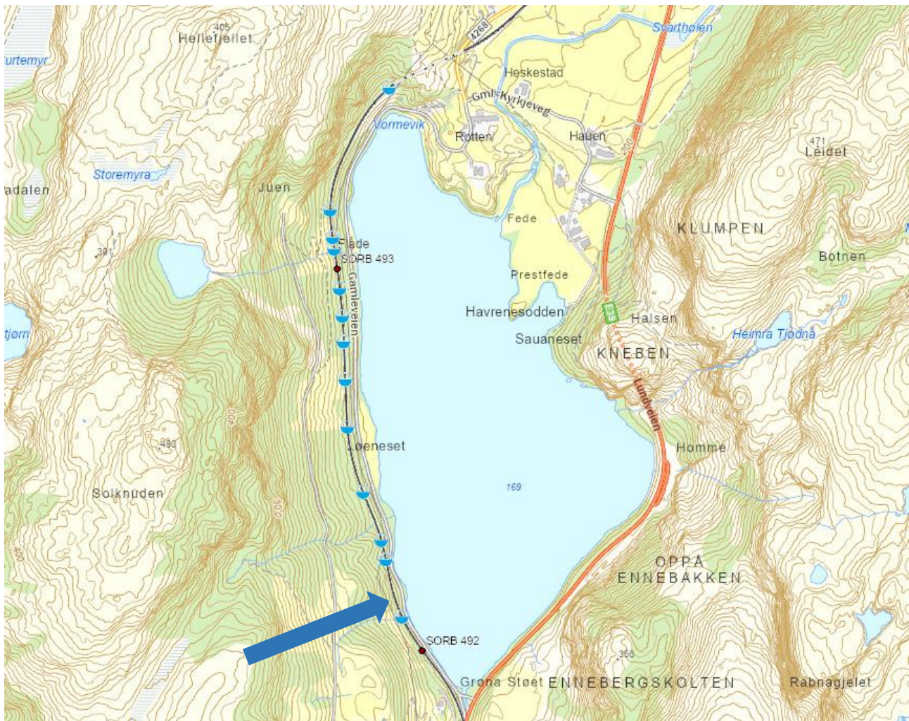
Figur 12: Heskestadlia ligger langs jernbanen på veststiden av sporet. Pilen viser skred-/avspøringsstedet. Det er totalt 13 stikkrenner under sporet langs denne strekningen, vist med blå halvsirkler. Kart: Bane NOR SF/Banekart. Påtegninger: SHK
