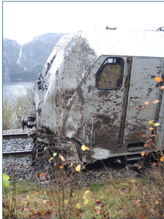
Figur 5: Skader i front av lokomotivet etter avsporingen. Foto: SHK
