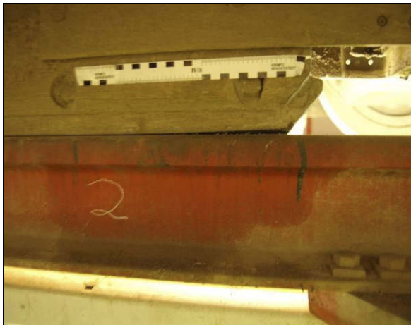
Figur 7: Viser magnetskinnebrems, buet og med slitt glideflate.
