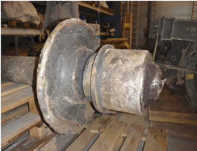
Figur 17: Indre del av hjulstomme samt aksel og hjullager.
