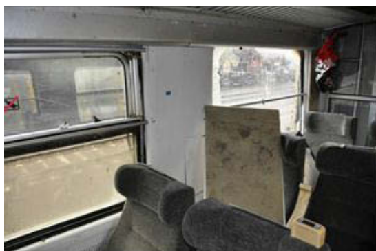
Figur 9: Viser sideplate som er løsnet.
