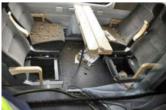
Figur 8: Viser stolputer som er løsnet.
