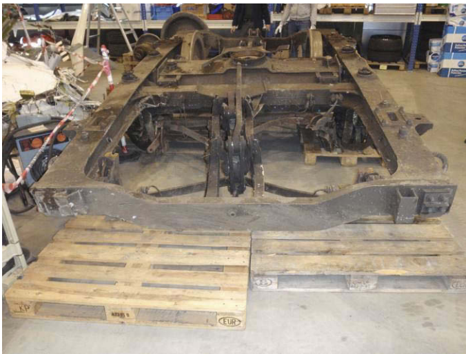
Figur 18: Boggirammen til hjulet som gikk til brudd.
