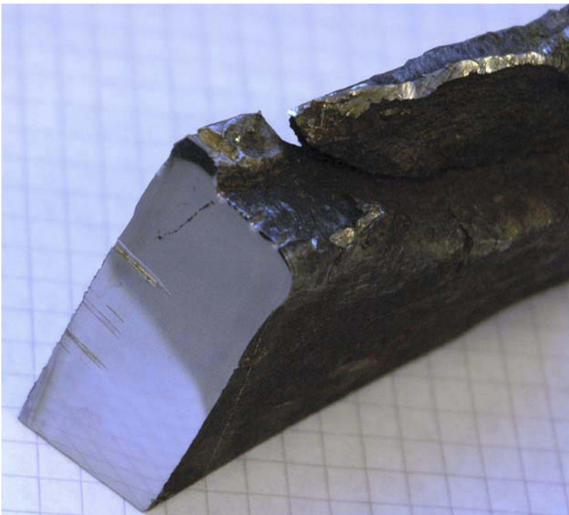
Figur 7 Bilde av sekundærsprekk i snitt ved bruddflate vist i Figur 4a.
