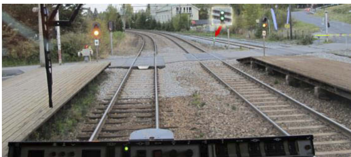
Figur 5: Togforsignalet viser to grønne faste lys. Tog i spor 2 kan passere stasjonen med største tillatte hastighet. (Kilde: SHT)
