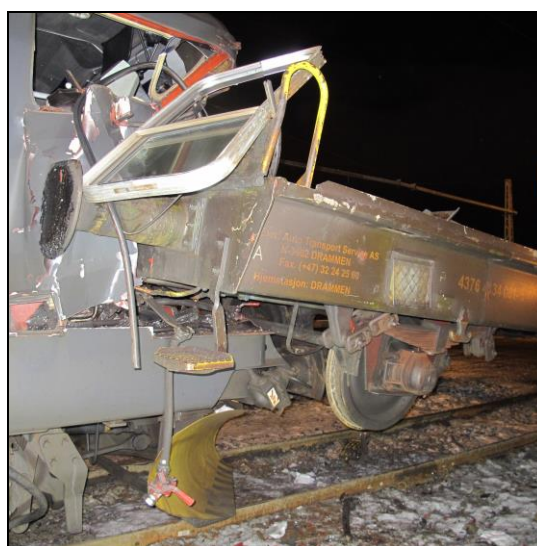
Figur 4: Viser skadene på lokomotivet til 5509. Foto: SHT
