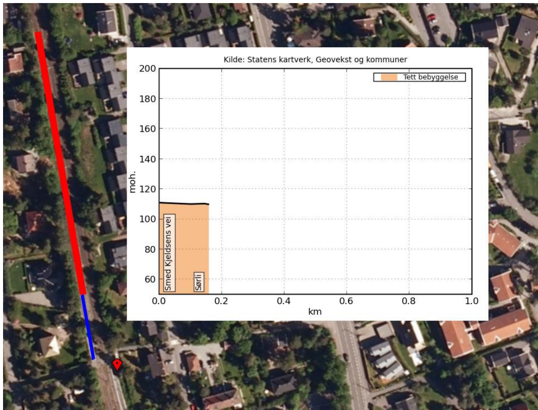
Figur 3: Høydeprofil ved Sørli holdeplass, rød strek er ca. 150 meters bremseavstand og blå strek er plattformen på ca. 40 meter. Kartgrunnlag: Statens kartverk, Geovekst og kommuner.
