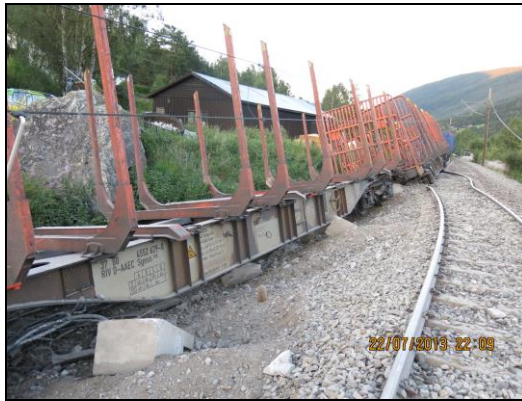
Figur 1: Bakre del av den avsporede vognstammen. Foto: SHT
