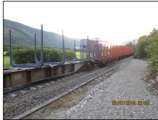
Figur 2: Fremre del av den avsporede vognstammen. Foto: SHT
