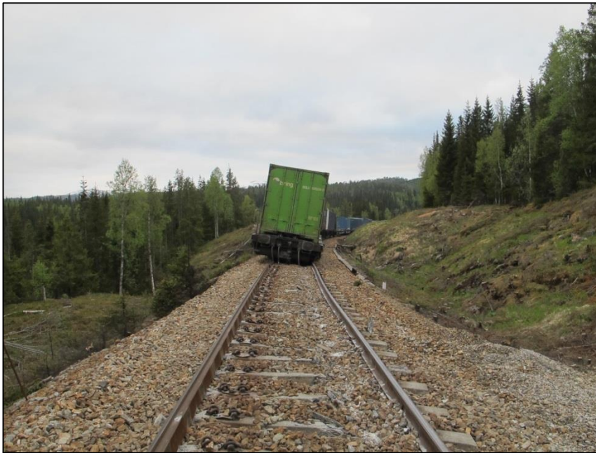
Figur 4: Bakre del av tog 5790 etter avsporingen. Foto: SHT
