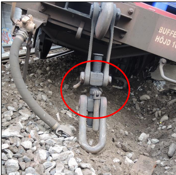
Figur 9: Tilstrammet kobbel i bakkant av avsporet vogn. Foto: SHT
