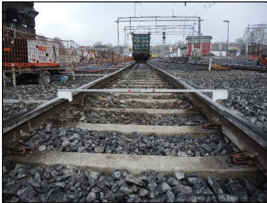
Figur 3: Mal for hjul viser hvor avsporet vogn klatret opp på skinnehode. Foto: SHT
