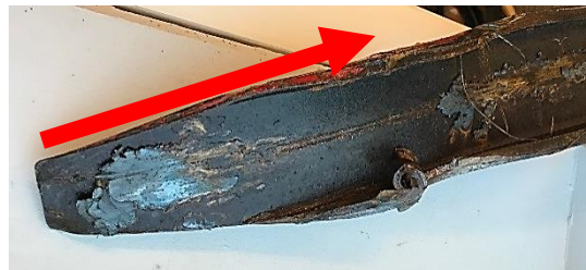
Figur 10: Undersiden av skadet bremsesko. Pilen viser fartsretningen. Foto: Bane NOR
