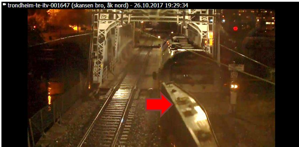
Figur 3: Pila viser første vogn på høykant. Kilde: Bane NOR
