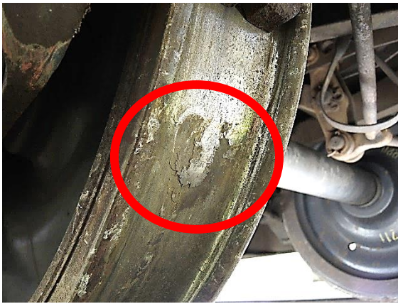
Figur 7: Høyre hjul har hjulslag. Foto: SHT
