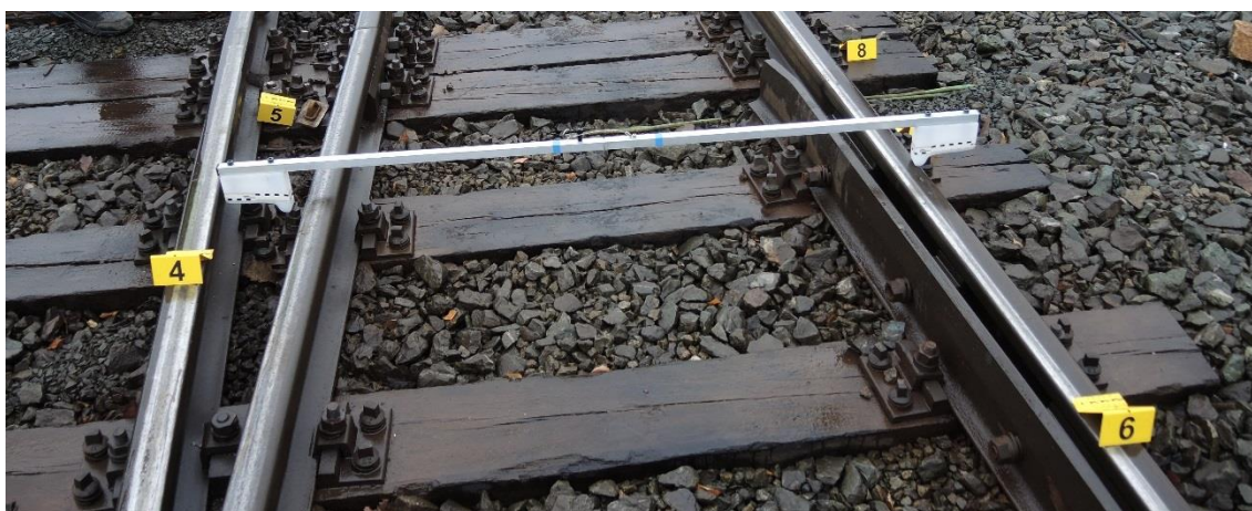
Figur 13: Undersøkelse av sporveksel. Markering nr. 5 er en del fra bremsesko. Foto: SHT
