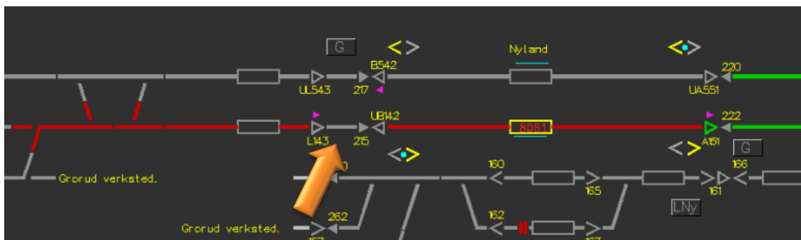
Figur 12: Klokken 23:27:36 er sporfeltet fritt (grå farge) med belegg foran og bak (rød farge). Kilde: Bane NOR
