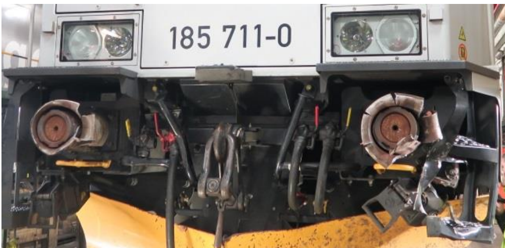
Figur 9: Skade på buffere på lokomotiv 711. Foto: SHT
