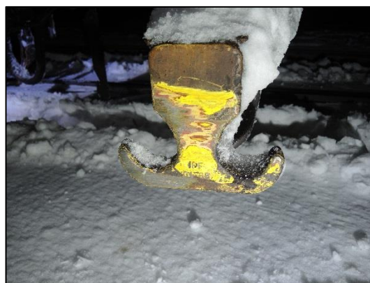
Figur 10: Skrapemerker på nedbindingskrok. Foto: SHT
