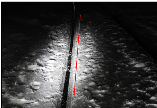
Figur 15: Spor fra venstre hjul bakre aksling vogn 3. Foto: SHT
