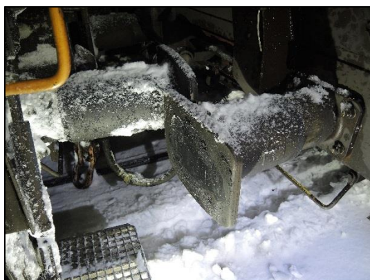
Figur 9: Ombufring mellom vogn 3 og 4. Foto: SHT
