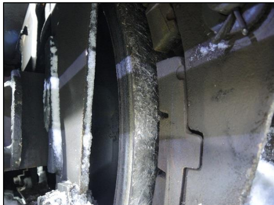
Figur 7: Skader på hjulbane vogn 3. Foto: SHT
