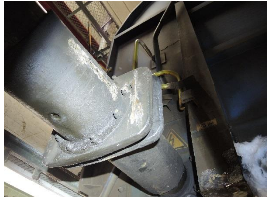
Figur 12: Skrapemerker på buffer etter ombufring. Foto: SHT
