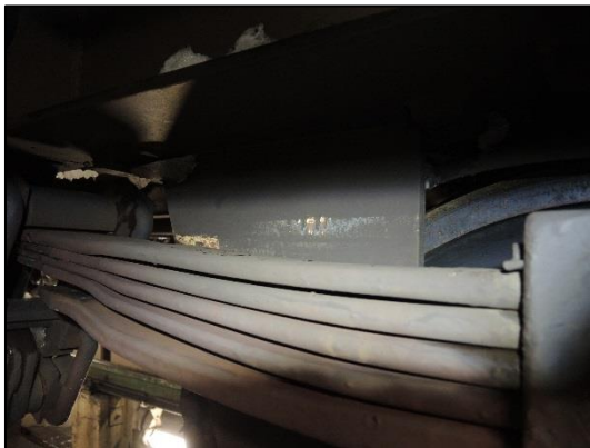
Figur 11: Skrapemerker viser kontakt mellom fjær og vognramme. Foto: SHT
