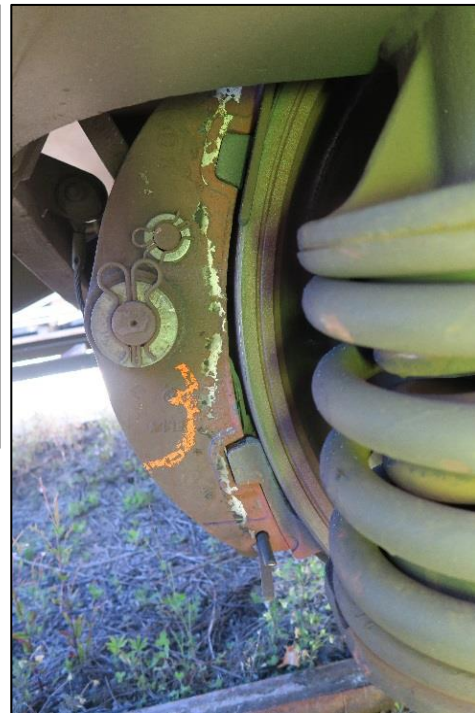
Figur 7: Bremsklosser som er slitt helt bort. Foto: SHT
