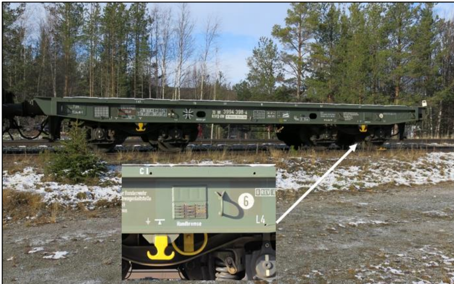
Figur 9: Parkeringsbrems på vogn D-BW 33 80 3994 398-4. Foto: SHT
