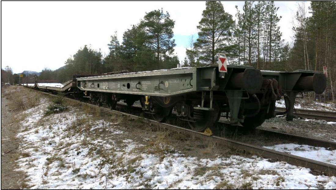
Figur 7: Vognstammen som rullet over sporsperren. Foto: SHT
