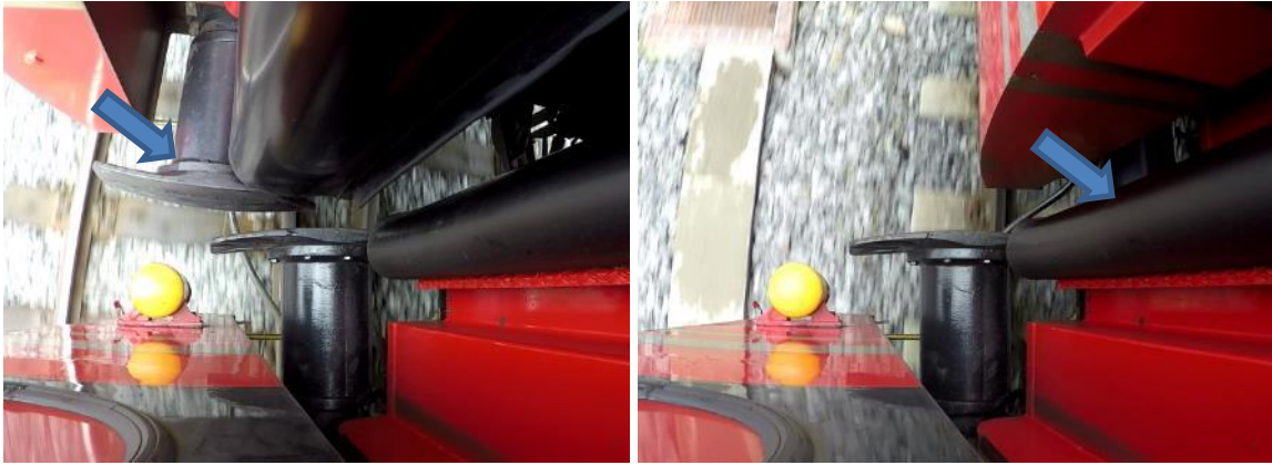
Figur 17: Store bevegelser på bufferen under testkjøringen i sporveksel 232A/B. Foto: SHT
