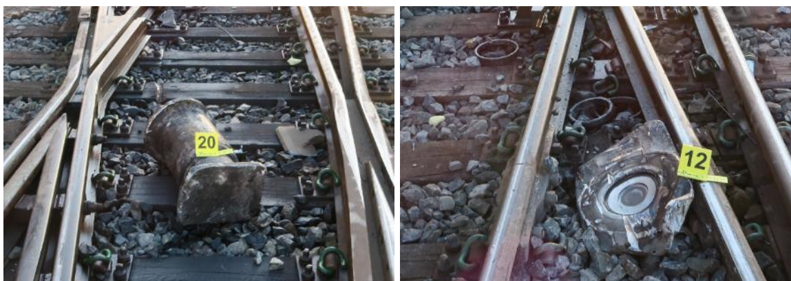
Figur 6: Markering 20 viser bufferen og markering 12 viser bufferplaten. Foto: SHT
