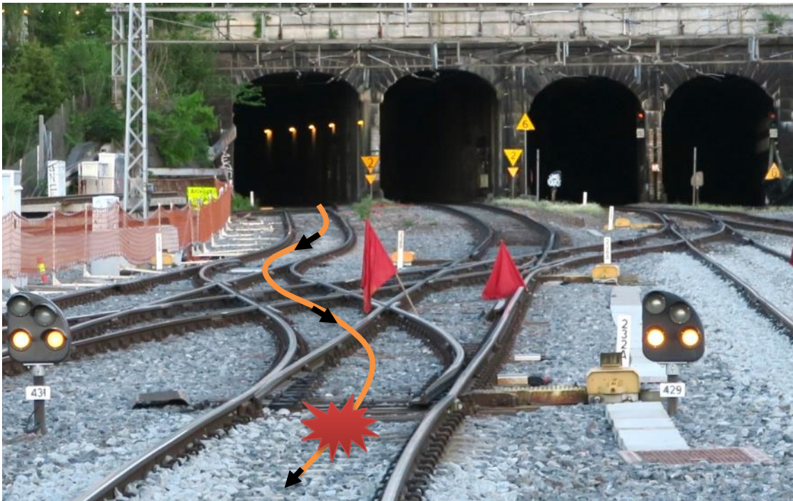
Figur 11: Sporsløyfe 232. Zoom på kamera gjør at kurven ser krappere ut enn den er. Foto: SHT
