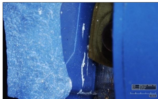
Figur 32: Kontaktmerker i plasten. Foto: FOLAT
