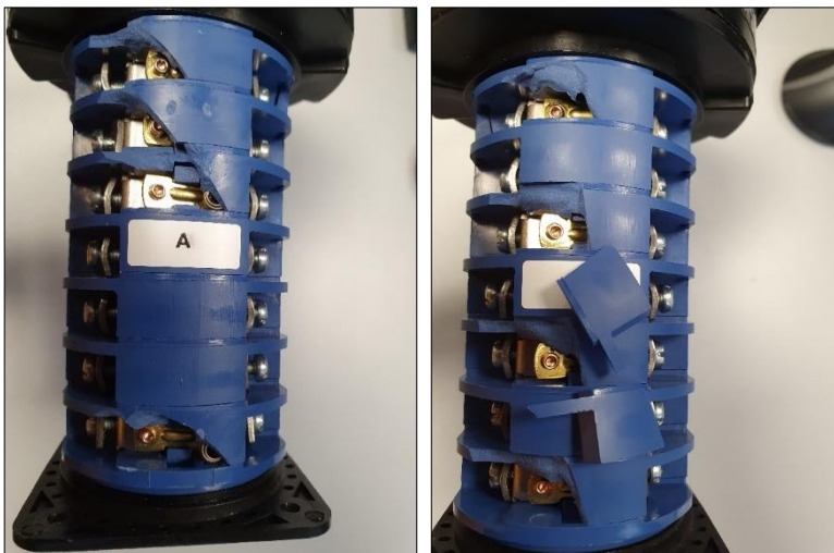
Figur 39: Fremprovosert tilsvarende skade med skrutrekker. Foto: Kraus & Naimer GmbH
