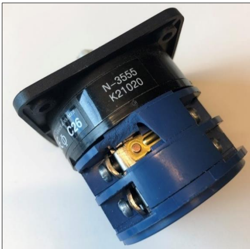
Figur 26: Skade ved koblingspunkt 2. Foto: SHK
