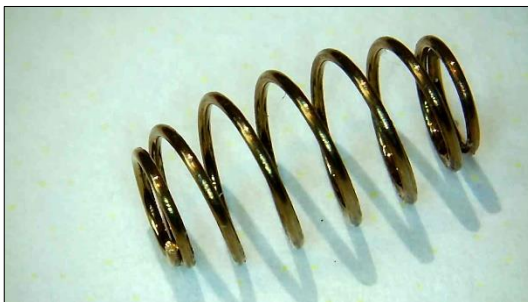
Figur 28: Fjær til kontaktbro. Foto: SHK
