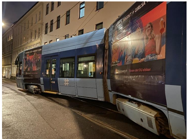
Figur 3: Situasjonen etter avsporingen. Foto: Sporveien Trikken AS
