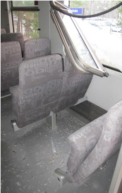
Figur 7: Vindu er slått inn. Foto: SHK
