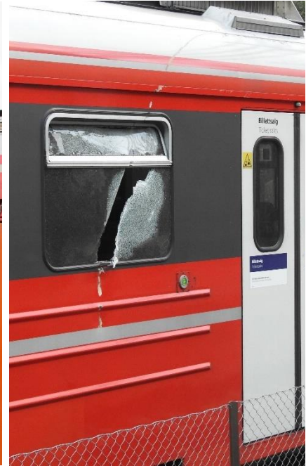
Figur 9: Knust vindu. Foto: SHK
