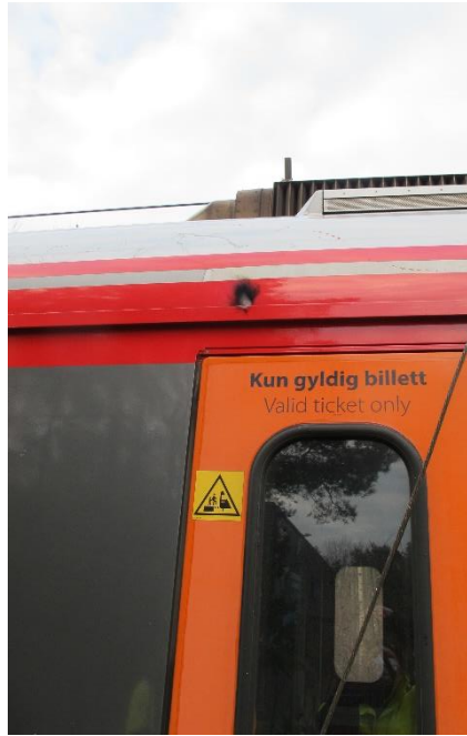
Figur 8: Svimerke i vognkasse. Foto: SHK
