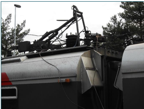
Figur 23: Bakre strømvaktaker er viklet inn i kontaktledningsanlegget. Foto: SHK
