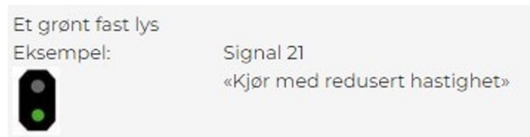
Figur 12: TJN Kapittel 8.16 Signal 21 «Kjør med redusert hastighet.» Kilde: Bane NOR SF
