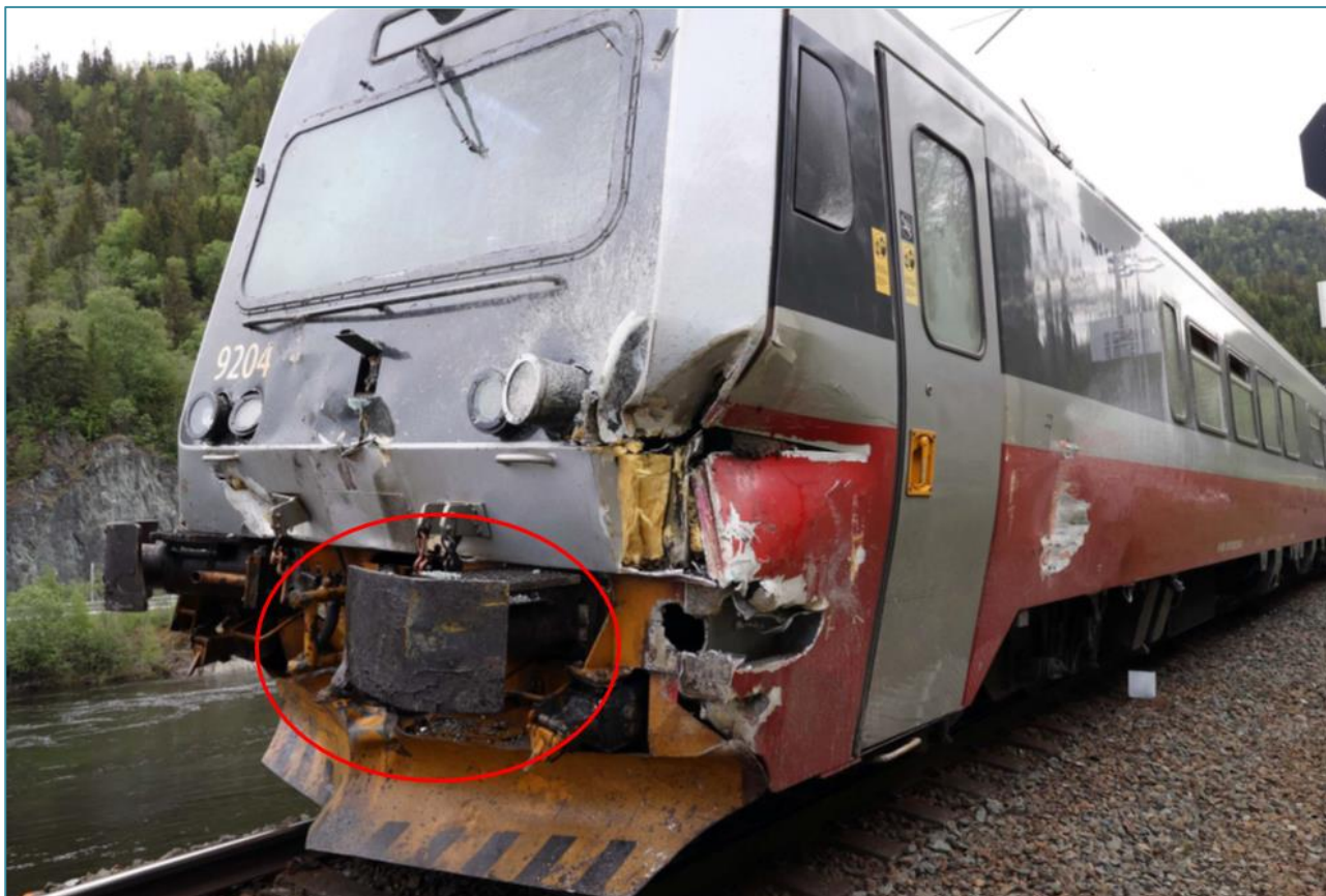
Figur 14: Skader på det involverte motorvognsettet. Gul maling observert på venstre buffer. Foto: Politiet med markering av SHK
