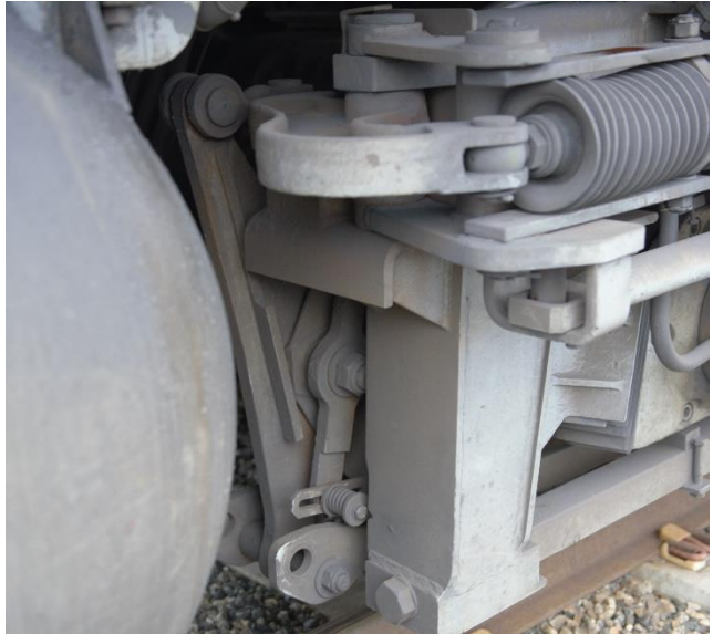
Figur 10: Parkeringsbrems med mekanisme og klossholder. Foto: SHK
