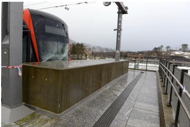
Figur 1: Vogn 228 etter sammenstøtet med endebutten. Foto: SHK
