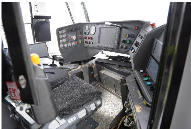
Figur 2: Førerplassen til vogn 228 etter sammenstøtet med endebutten. Foto: SHK
