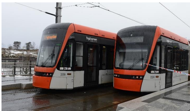
Figur 5: Vogn 228s (til høyre) uskadde ende med uskadet profil (ref. skadet profili figur 3). Foto: SHK
