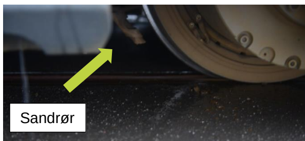
Figur 20: Sandrør, hjul og skinnetopp. Foto og påtegning: SHK
