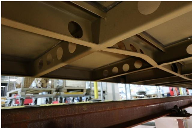
Figur 12: Deformasjon av rammeverk på vogn 228. Foto: SHK
