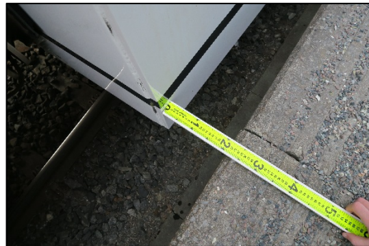
Figur 16: Avstand ved enden av vognen ble målt til 220 mm mellom plattform og MX 3000 på Holstein T-banestasjon. Foto: SHT
