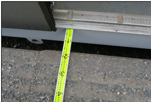
Figur 15: Avstand ved dør ble målt til 160 mm mellom plattform og MX 3000 på Holstein T-banestasjon. Foto: SHT
