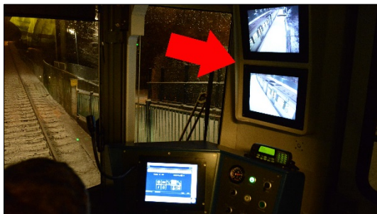
Figur 8: Monitorer fra togsidedkamera i førerrommet. Foto SHT
