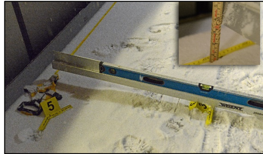
Figur 13: Måling av fall på plattformen. Foto: SHT
