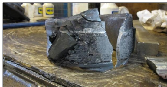
Figur 44: Innerring fra indre lager med skråstilt rulle. Foto: SHK
