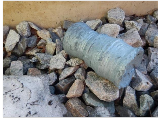
Figur 16: Akseltapp funnet langs sporet. Foto: Bane NOR SF
