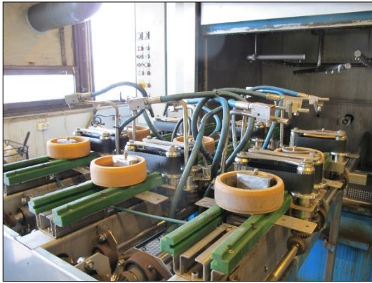
Figur 85: Vaskefasiliteter for aksellagre. Foto: SHK
