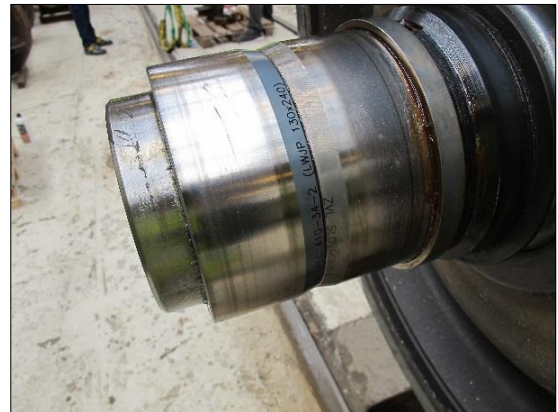
Figur 60: Begge innringer på motsatt side er produsert av ZVL. Foto: SHK
