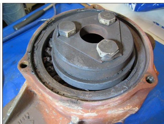
Figur 36: Bolter med låseblikk intakt. Foto: SHK
