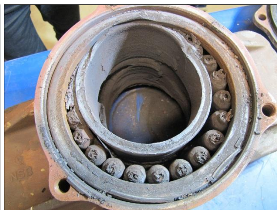
Figur 38: Ytre lager med ruller. Foto: SHK
