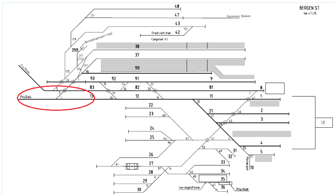
Figur 1: Sporplan for Bergen Stasjon, med rød ring markerer avsporingen. Kilde: Bane NOR SF
