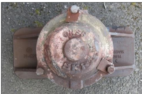
Figur 21: Akselkassehus utvendig. Foto: SHK
