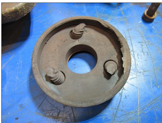
Figur 37: Boltene er slitt av. Foto: SHK
