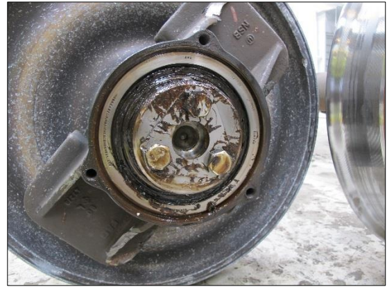
Figur 58: Demontering av lager på motsatt side, før rengjøring. Foto: SHK
