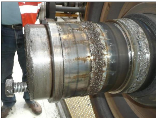
Figur 77: Hjulaksel med innringer, distansering og endebrikke etter demontering. Foto: CargoNet AS
