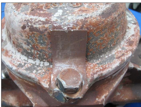
Figur 35: Utside akselkassehus og skilt med verksted, dato og fettype. Foto: SHK
