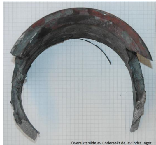
Figur 62: Del av indre lagerbane. Foto: FOLAT
