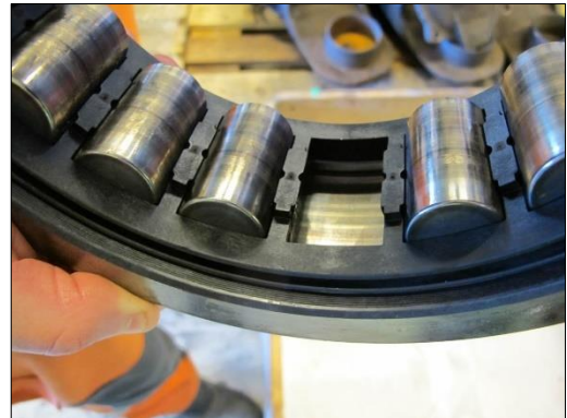
Figur 88: Mulighet for inspeksjon av ytre rullebane på ZVL-lager. Foto: SHK
