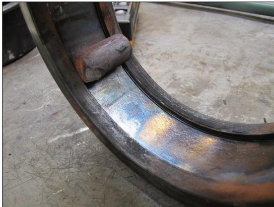
Figur 55: Ytre lagerbane med en rulle fra havarert lager. Foto: SHK
