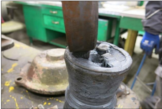
Figur 53: Endebrikkens tykkelse vist mot det som var igjen av bolter i akseltapp. Foto: SHK
