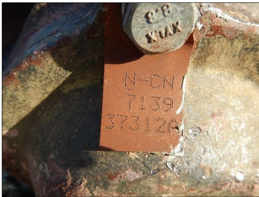
Figur 17: Merking på hjulsats. Foto: Bane NOR SF
