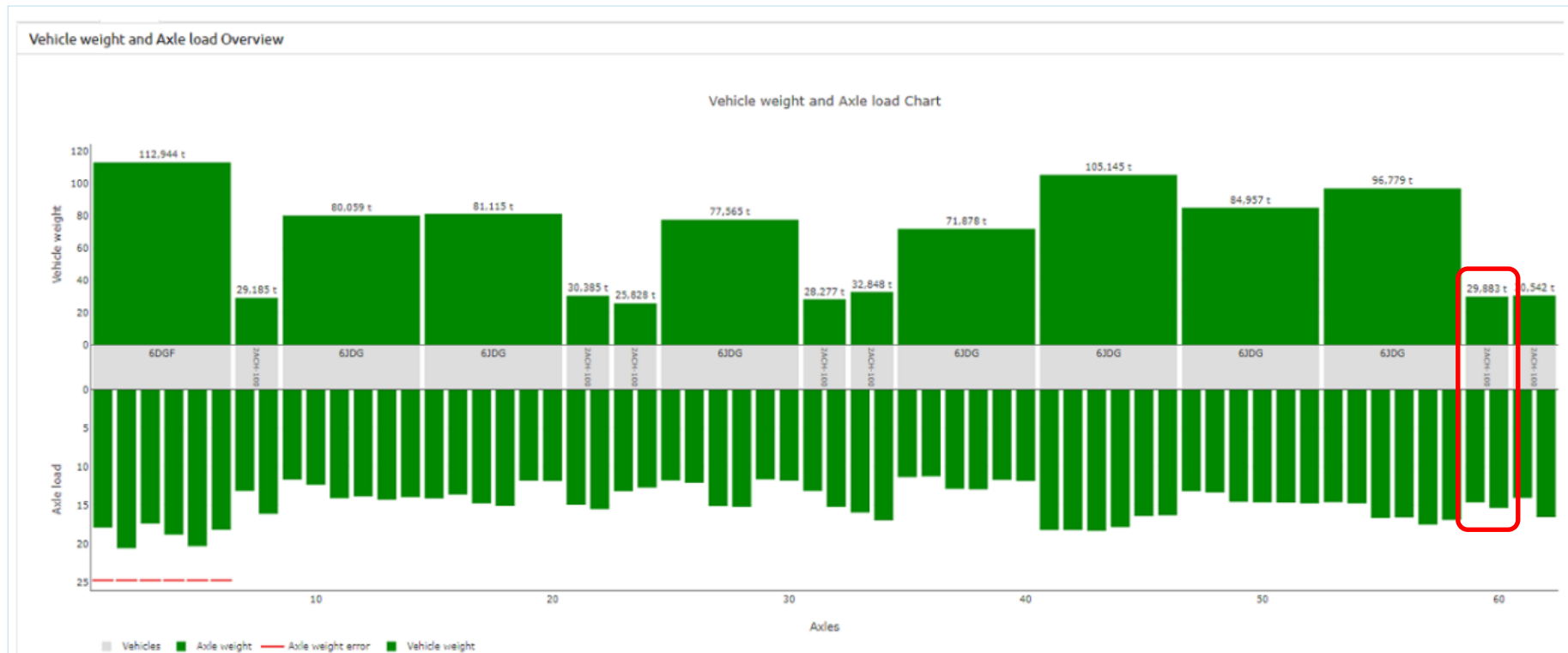
Figur 104: Aksellast og vognlast for tog 5511 registrert av detektor ved Huseby. Kilde: Bane NOR SF / CargoNet AS
