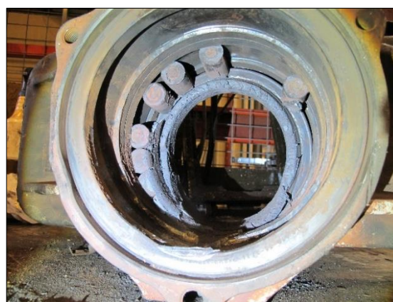
Figur 42: Ruller ses i indre lager. Foto: SHK
