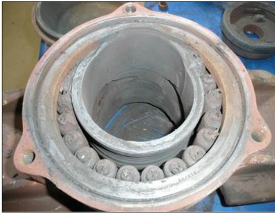
Figur 94: Aksellager fra tog 5511 (Bergen). Foto: CargoNet AS
