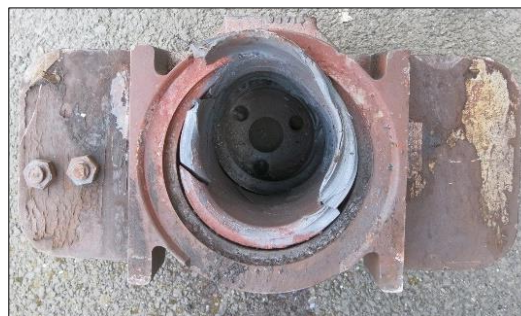
Figur 22: Akselkassehus med skadet lager. To løse bolthoder ble funnet. Foto: SHK
