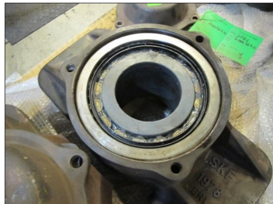
Figur 78: Akselager med plasthylse for styring inn på aksel. Foto: SHK
