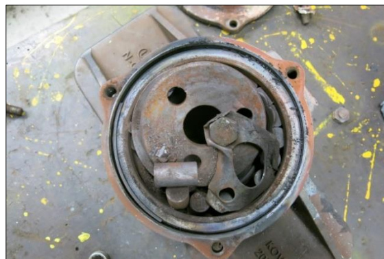
Figur 50: Låseblikk med et bolthode. Foto: SHK
