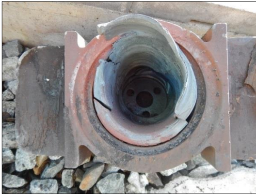
Figur 15: Akselkassehus funnet i sporet. Foto: Bane NOR SF
