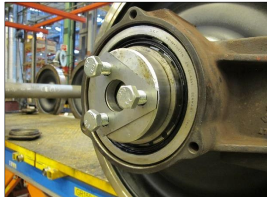
Figur 80: Låseblakk og sekskantskruer før tiltrekking. Foto: SHK
