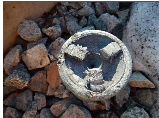
Figur 18: Akseltapp med 3 bolter. Foto: Bane NOR SF
