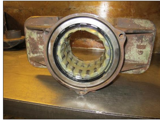
Figur 86: Revidert lager i akselkassehus. Foto: SHK
