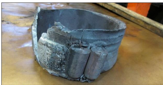
Figur 43: Innerring fra indre lager med deformerte ruller. Foto: SHK
