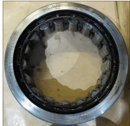
Figur 30: Eksempel på revidert aksellager klart til bruk (ytterring og ruller i rullebur). Foto: SHK
