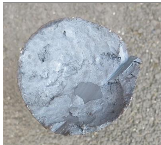
Figur 20: Bruddflate i akseltapp. Foto: SHK
