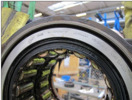
Figur 59: Ytterringer og ruller på motsatt side (begge) av havareert lager er produsert av FAG. Foto: SHK
