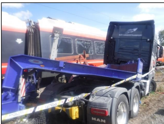
Figur 16: Trekkbilen og svanehalsen. Foto: Vy Berging og beredskap Jernbane AS
