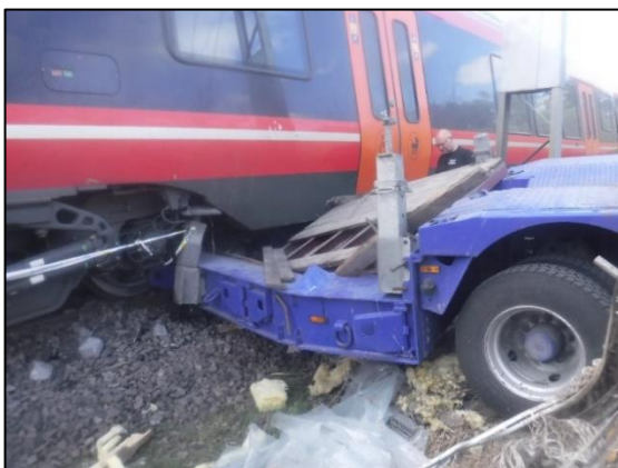
Figur 14: Hengeren under toget. Foto: Vy Berging og beredskap Jernbane AS
