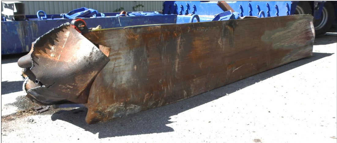
Figur 30: Skrapemerker under den bakre vangedelen på trallens venstre side. Foto: SHK
