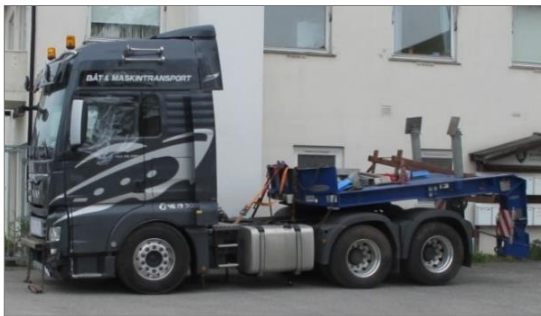
Figur 8: Trekkbil med svane. Foto: SHK
