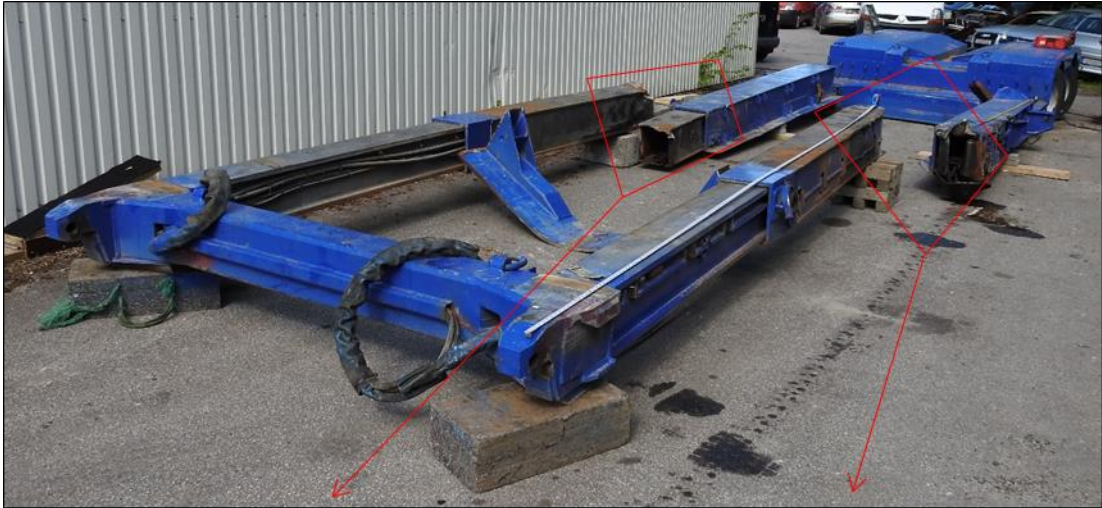
Figur 26: Trallen uten svanehalsen, kuttet i flere deler etter kollisjonen (detaljbilder i figur 27 og figur 28). Foto: SHK
