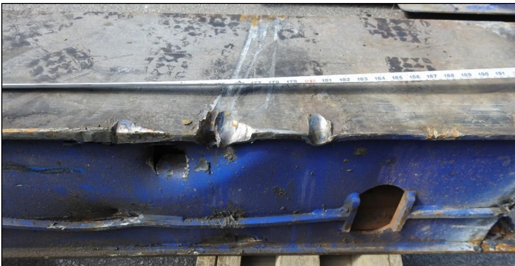
Figur 25: Merker etter flensene på togets hjul. Foto: SHK
