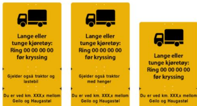
Figur 65: Opplysningskilt for lange eller tunge kjøretøy i kombinasjon med underskilt. Kilde: Bane NOR teknisk regelverk
