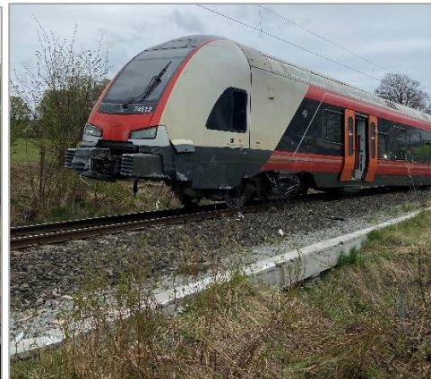
Figur 60: Fronten etter kollisjonene. Foto: Vy Berging og beredskap
