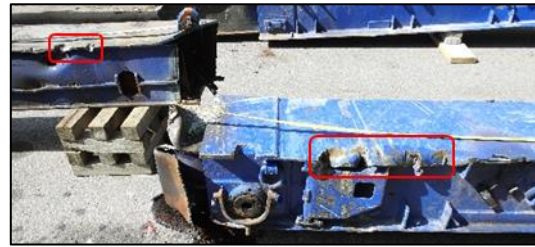
Figur 28: Merker etter togets hjul på venstre rammevange. Foto: SHK
