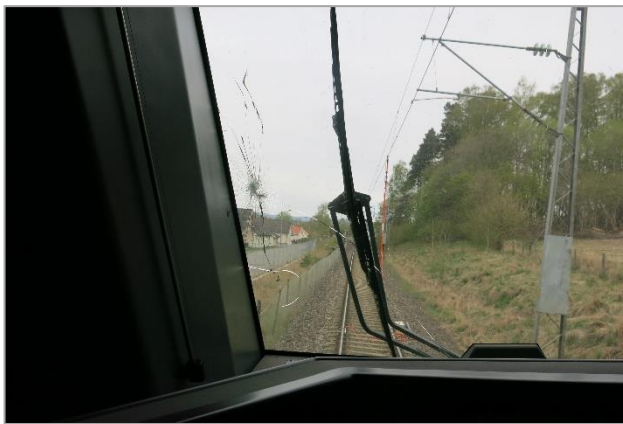
Figur 59: Sprekker i frontruten. Foto: SHK
