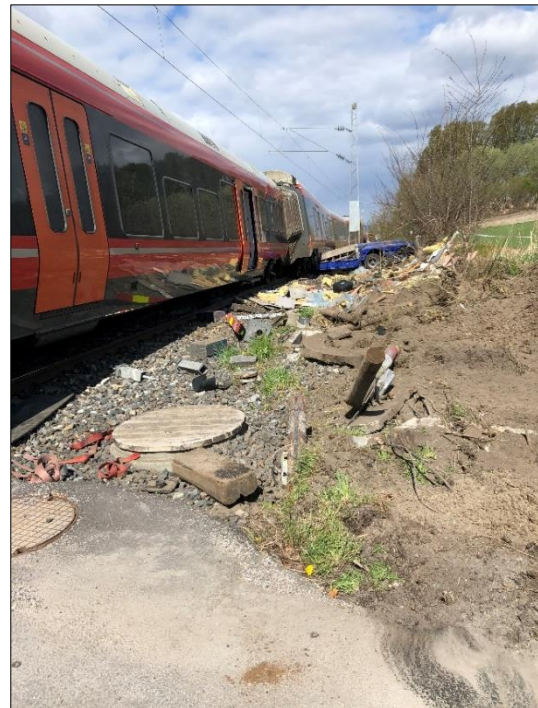
Figur 5: Trallen har revet med seg kiosken til veisikringsanlegget. Foto: Vygruppen AS
