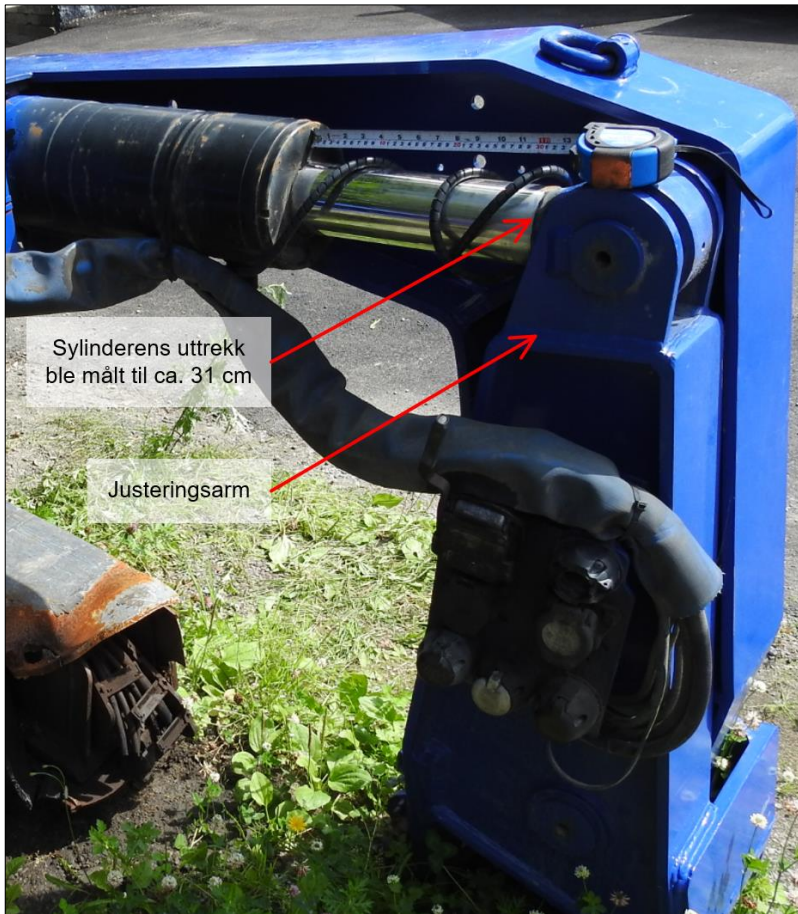
Figur 21: Sylinderens uttrekk på trallens høyre side. Foto: SHK
