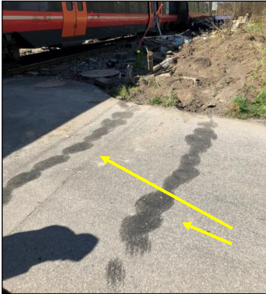
Figur 40: Merker etter trallens hjul på østsiden av planovergangen. Foto: SHK
