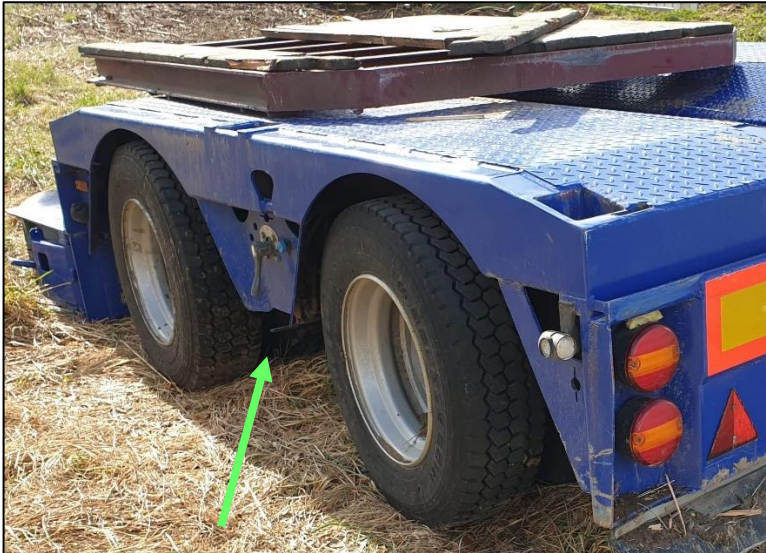
Figur 24: Reguleringshåndtak i posisjon utover. Foto: Grenland Bilberging
