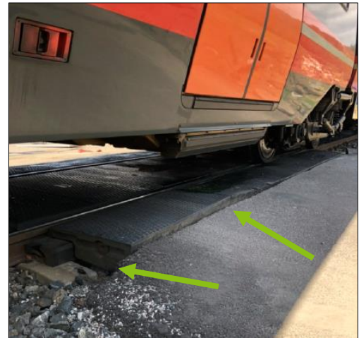
Figur 50: Forskyvning og sammenstrykking av Straiement 1 og 2. Foto: Politiet
