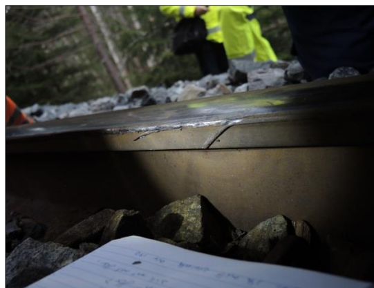
Figur 5: Avsporingmerke. Foto: SHT
