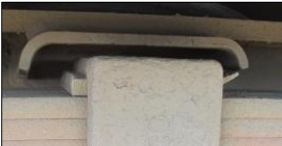
Figur 31: Fjærklaring under 15 mm på vogn 049-4 (Alnabru 19. april 2014). Foto: SHT
