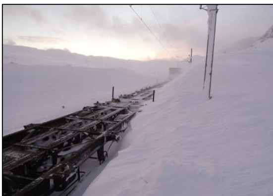
Figur 17: Togstammen ble pakket inn med snø i løpet av noen timer etter avsporingen. Foto: Jernbaneverket
