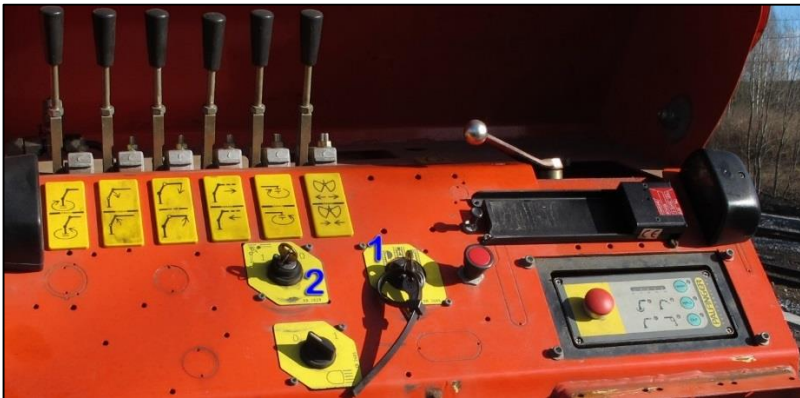
Figur 6: Sperrefunksjon for begge sider er aktiv (1) og høydebegrensingen aktiv (2). Foto: SHT
