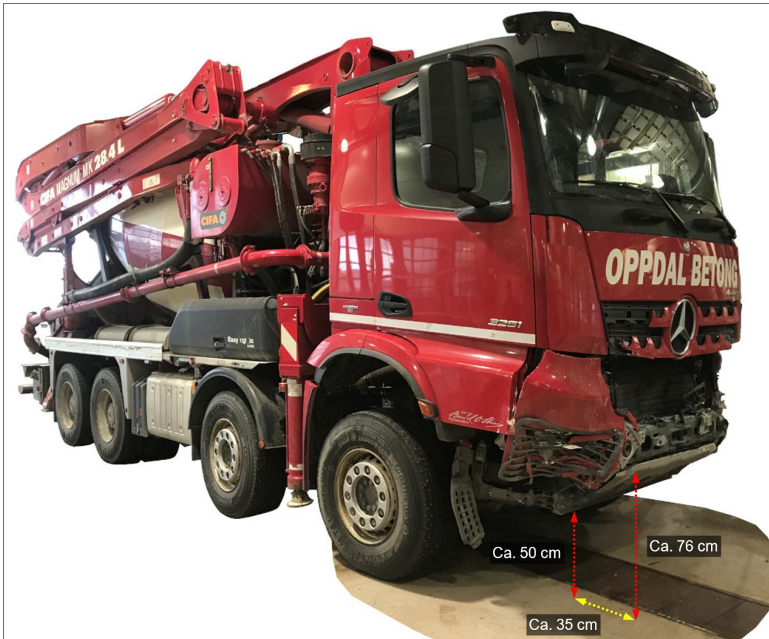
Figur 6: Lastebilen sett skrått frammanfrå, med mål på høgda mellom bakkeplanet og punktet der fronten begynte å skrå bakover til ein tverrstolpe, høgda mellom bakkeplanet og undersida av denne stolpen og omtrentleg horisontal avstand mellom desse to punkta. Foto og illustrasjon: SHK
