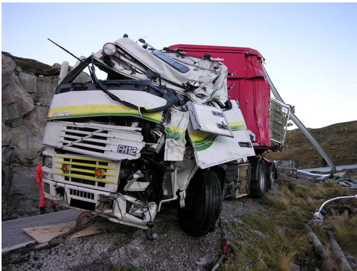
Figur 3: Skader på førerhuset
