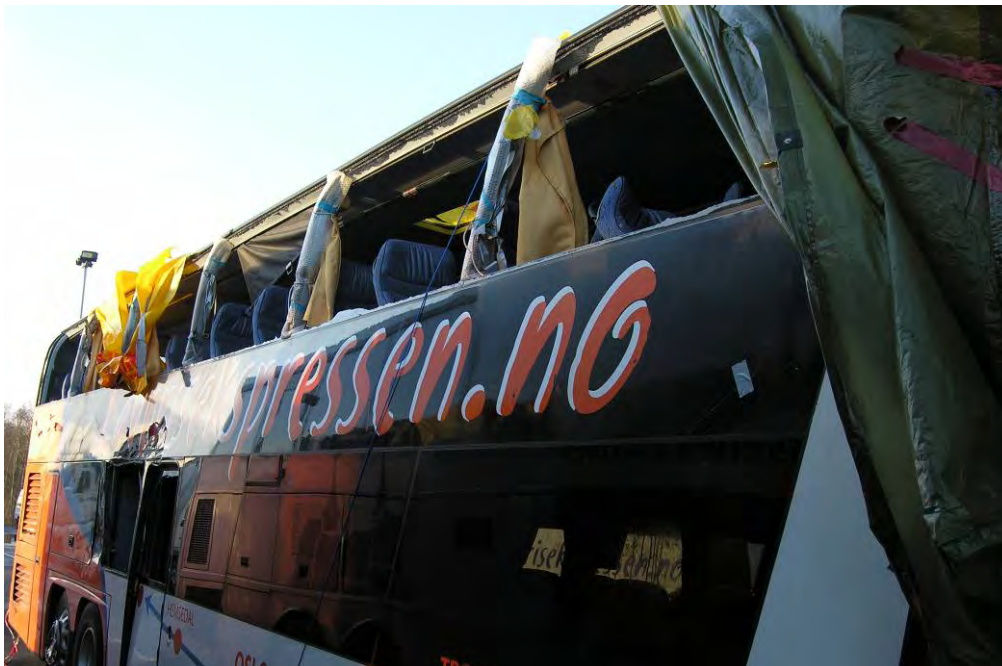
Figur 7: Skader på bussens høyre side.
