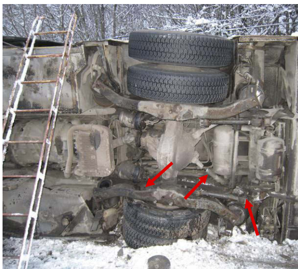
Figur 9: Bakaksel slått ut av stilling på venstre side. Pilene viser brudd i stagene som holdt bakakselen i riktig posisjon.
