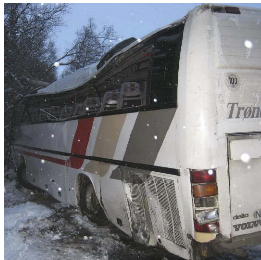
Figur 10: Deformasjon av bussens tak over en lengde på ca. 6 meter.
