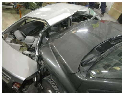
Figur 3: Rekonstruksjon som viser kjøretøyenes innbyrdes posisjoner i kollisjonsøyeblikket.
