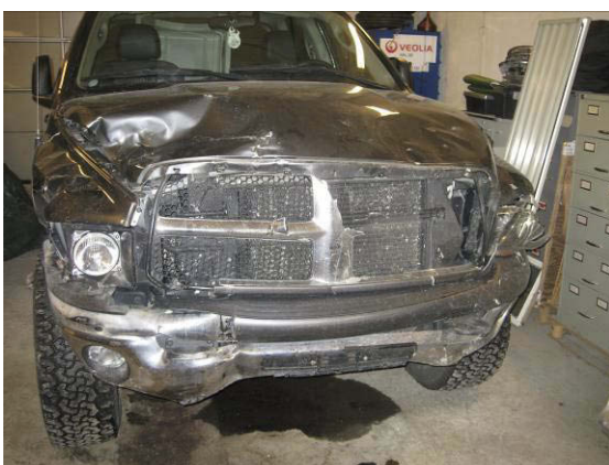
Figur 5: Skader i front på Dodge Ram.
