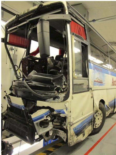
Figur 7: Viser skader etter sammenstøtet med personbil (A). (Foto: Statens vegvesen)
