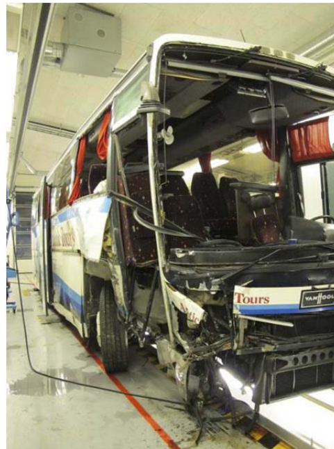
Figur 8: Viser skader etter sammenstøtet med minibuss (E). (Foto: Statens vegvesen)
