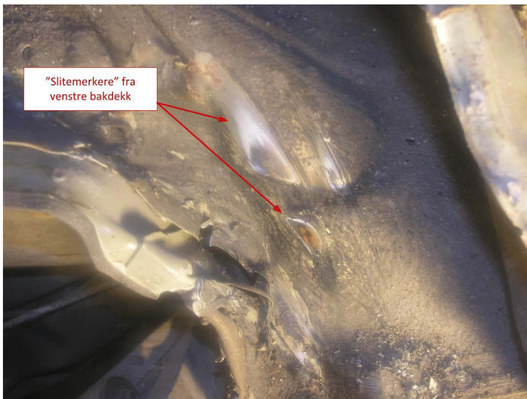
Figur 8: Viser slitemerker i hjulbue på høyre side bak. Slitemerkene er avsatt etter at høyre bakdekk har subbet mot hjulbuen.
