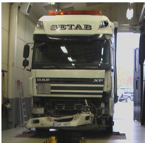
Figur 6: Skader i front på trekkbilen.
