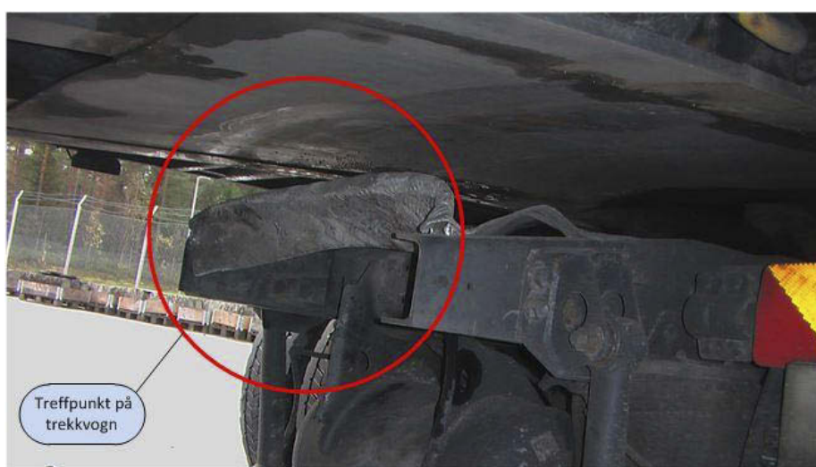
Figur 7: Bildet viser skader på trekkbilen sett skrått bakfra fra høyre side. Enheten over den røde sirkelen er undersiden av semitraileren.
