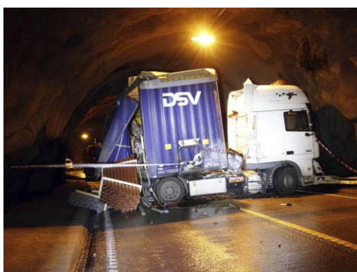
Figur 8: Skader på presenning og front av semitraileren. (Foto: Politiet)
