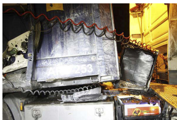
Figur 9: Skader i front på semitraileren. Foto: Politiet
