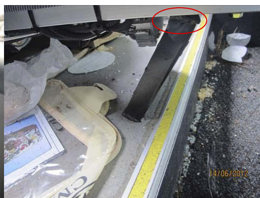
Figur 9: Viser deformasjon av stol som følge av belastninger fra personer i utforkjøringen, hvor blant annet gulvfestet er bøyd og løsnet fra setet. (Foto: SHT)
