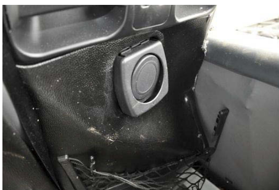
Figur 8: Viser skader på seterygg påført av personer i bevegelse inne i bussen. (Foto: SHT)
