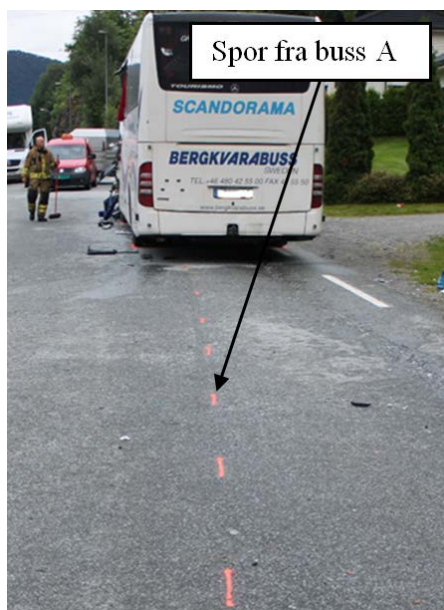
Figur 16: Spor fra buss A tydeliggjort med oransje stiplet linje merket i asfaltdekket. Foto: Statens vegvesen
