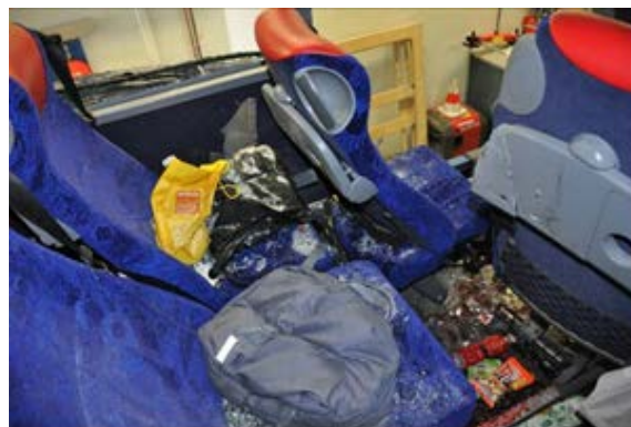
Figur 3: Seterad nr. 3. Bildet viser også at setet ved vinduet på seterad nr. 2 (der den omkomne satt) er presset bakover. Foto: SHT
