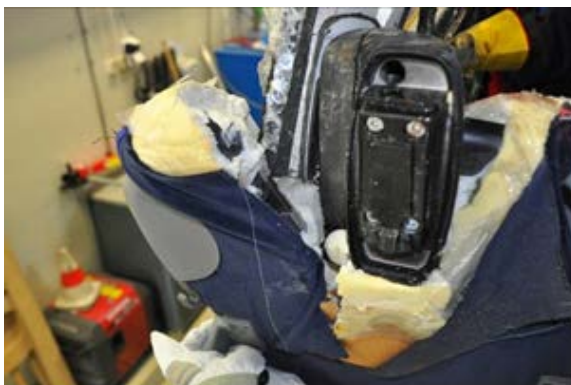
Figur 2: Bilde fra rekonstruksjon og undersøkelse av buss A etter ulykken. Bildet viser at A-stolpe med innfestingsbrakett (fra buss B) passer overens med skader på seterygg på rad nr. 1. Seteryggen ble avrevet i kollisjonen. Bildet er tatt i forbindelse med rekonstruksjonen, da seteryggen ble plassert tilbake på plass. Foto: SHT
