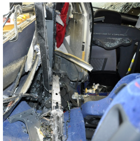
Figur 5: Figuren viser det samme som i figur 4 fra en annen vinkel. Den omkomne passasjerens sitteplass er til høyre i bildet, med deformert hylle/bord på veggen foran setet (bak førerstolen). Foto: SHT
