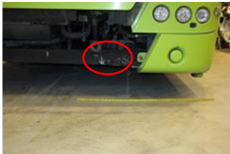
Figur 10: Sirkelen viser hvor bussen traff betongrekkverket, ca. 83 cm fra høyre side på bussen. Foto: SHT
