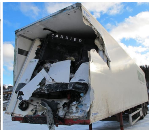
Figur 5: Semitrailerens skader i fronten og på venstre side. Foto: SHT
