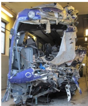
Figur 6: Bussens skader i fronten. Foto: SHT
