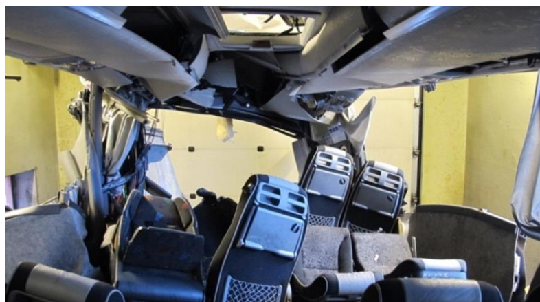
Figur 7: Bussens innvendige skader i fronten. Foto: SHT
