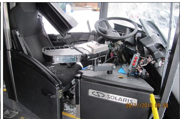
Figur 5: Førerplassen fikk en inntrykning, blant annet ble dashboard og stol forskjøvet. Foto: SHT
