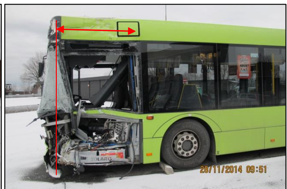
Figur 9: Bussens skader sett fra siden. Foto: SHT
