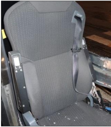
Figur 3: Bilbeltet har merker som viser at det er brukt. Foto: SHT
