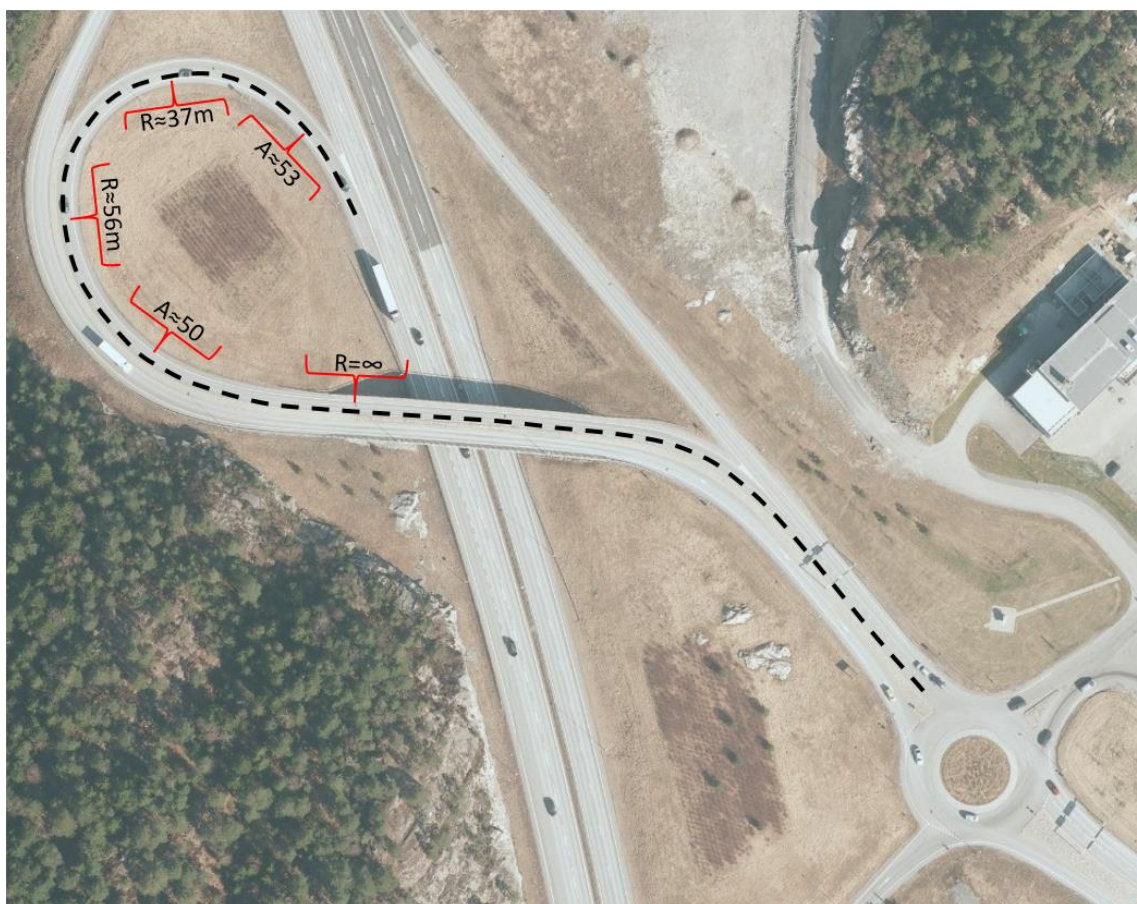
Figur 7: Flyfoto av påkjøringsrampen ved Svinesundparken med innmålte geometriske verdier. A (klotoidparameter) og R (radius). Kilde: Statens vegvesen og WSP
