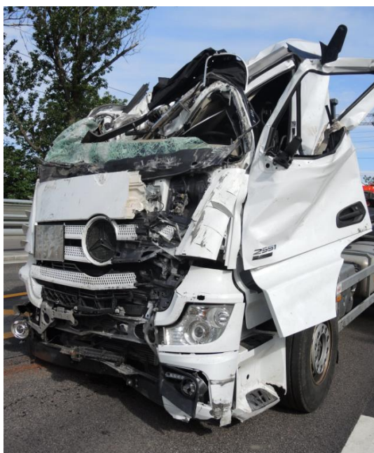
Figur 7: Lastebilen fikk omfattende skader på førerhytta i ulykken. Skadene var spesielt store i hyttas øvre del. Foto: SHT
