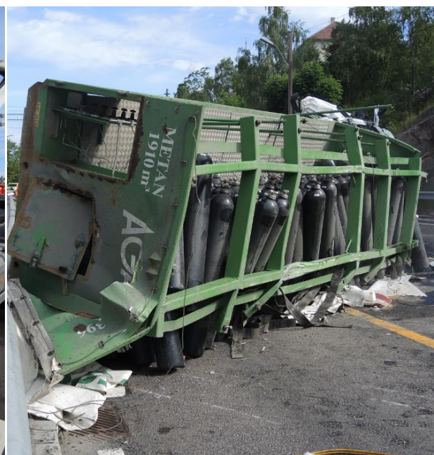
Figur 8: Lasteflaket med gassbeholderne fikk også store skader i ulykken. Foto: SHT
