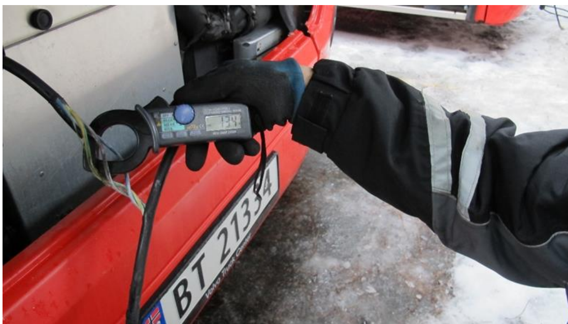
Figur 15: Måling av strømstyrke med tangamperemeter. Foto: SHT
