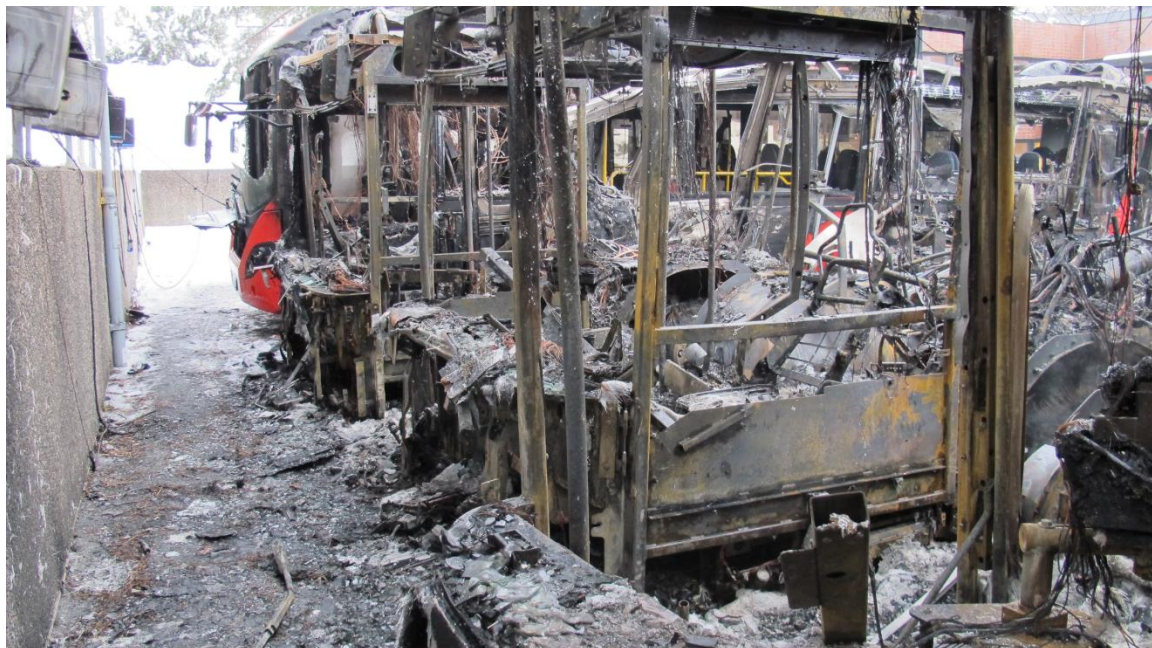
Figur 8: Frontene på de utbrente bussene. Kabeltromlene i øvre venstre hjørne i bildet førte 230 V strøm til 309-støpsel i bussenes front. Foto: SHT
