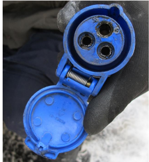
Figur 10: Endestykket på kabelen, som kobles til 309-støpselet i bussen. I likhet med figur 9 vises også smørefettet her. Foto: SHT
