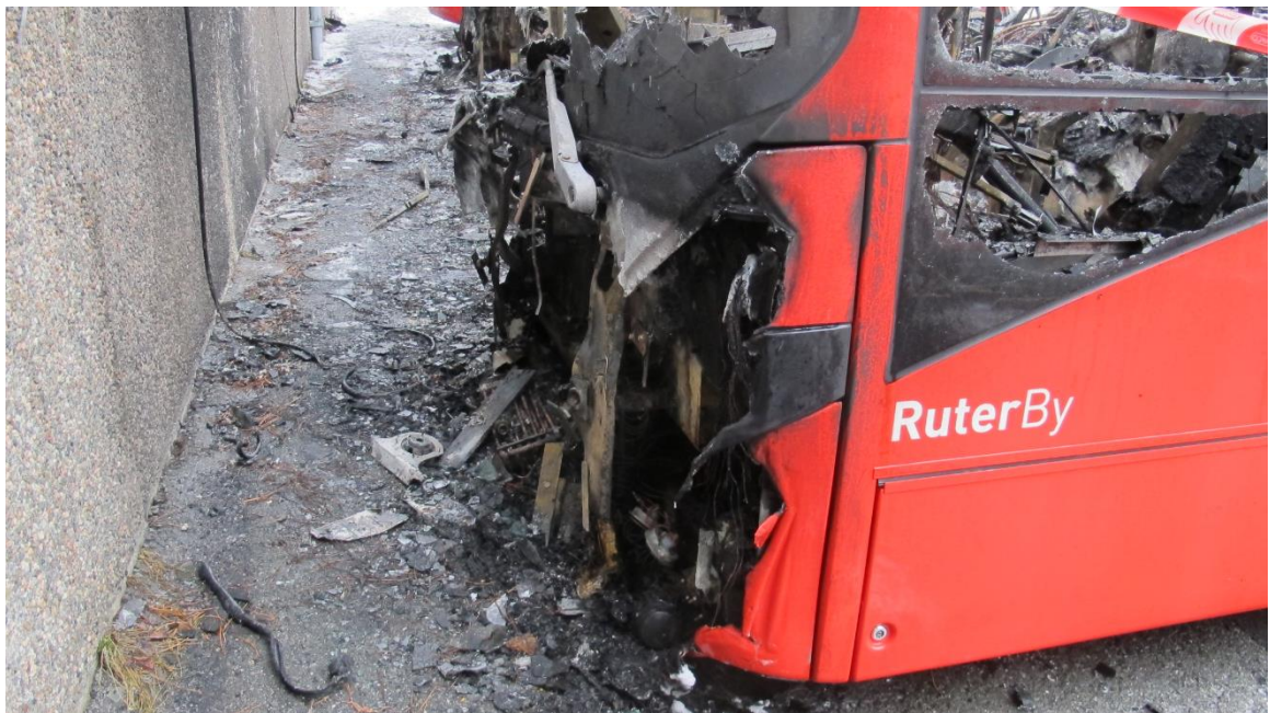
Figur 11: Arnestedet ble påvist å være høyre side foran på buss nummer en, sentrert i dette bildet. Foto: SHT
