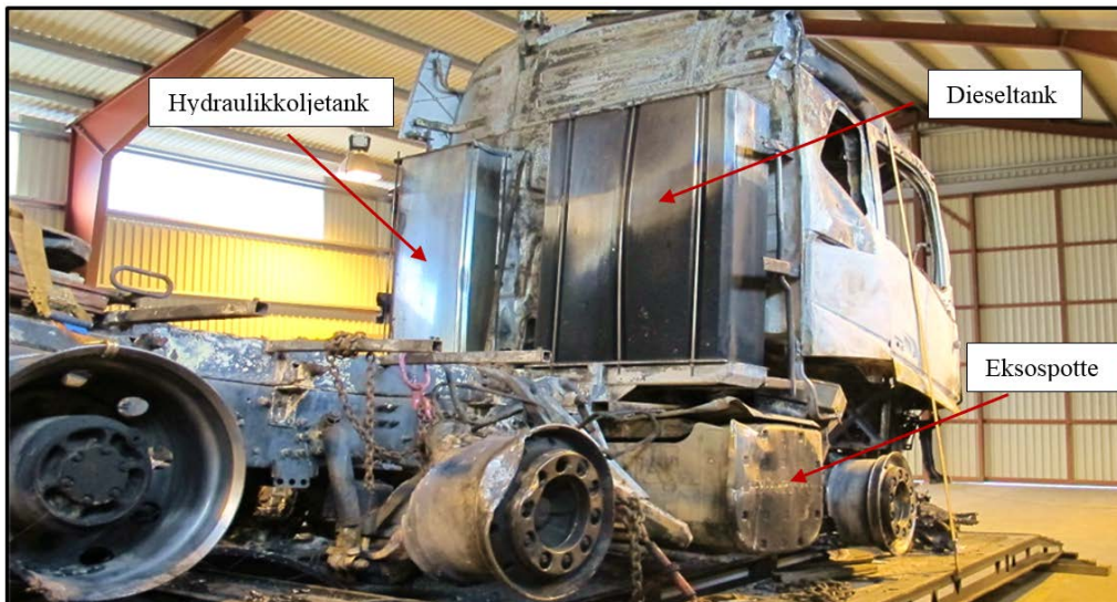
Figur 3: Lastebilens brannskader med markert eksosanlegg, hydraulikk- og dieseltank. Foto: SHT
