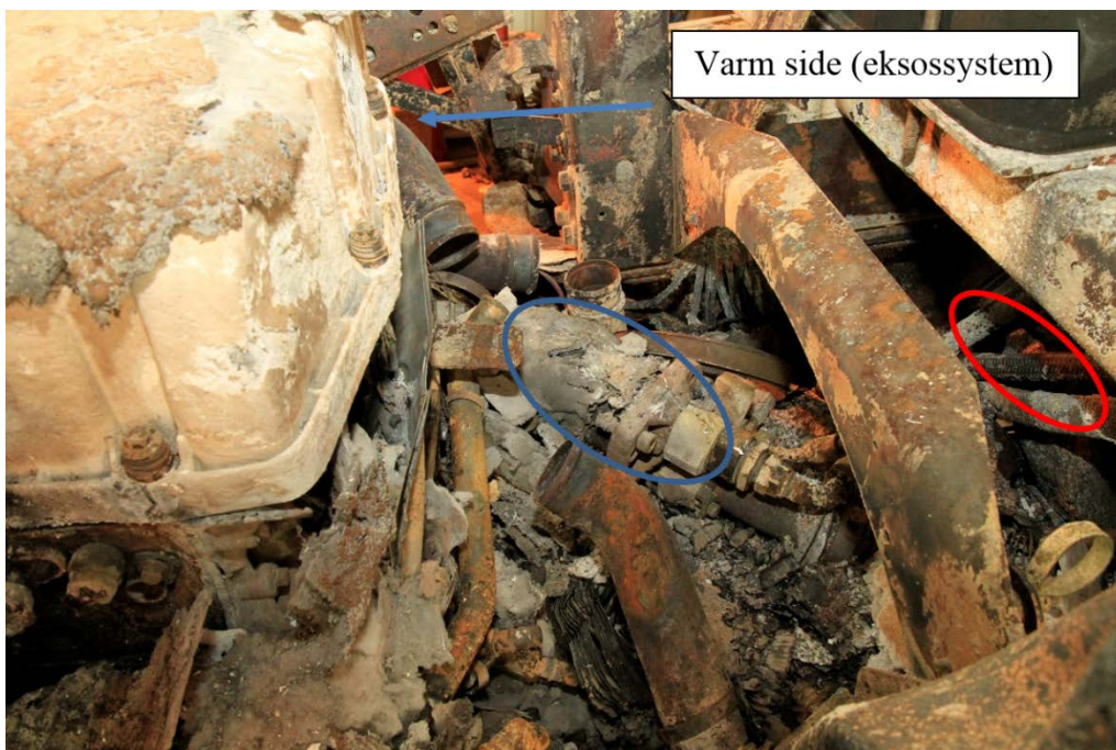
Figur 5: Hydraulikkpumpe (blå ring) installert bak motor og slanger med slitasjeskader (rød ring). Varme flater (eksosystem) er i område blå pil. Foto: Kripos. Illustrasjon: SHT
