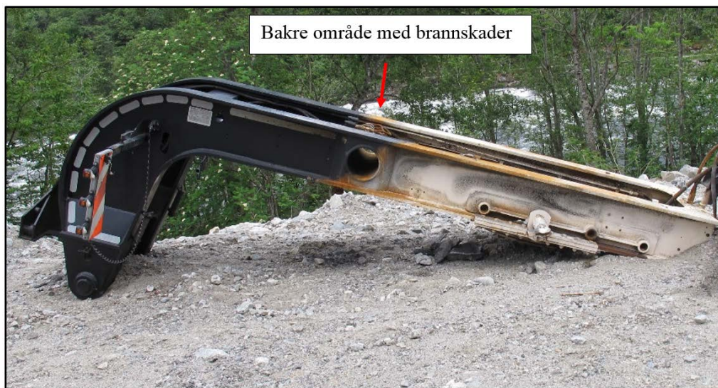
Figur 4: Brannskader på fremre del av semitraileren (svanehalen). Foto: SHT
