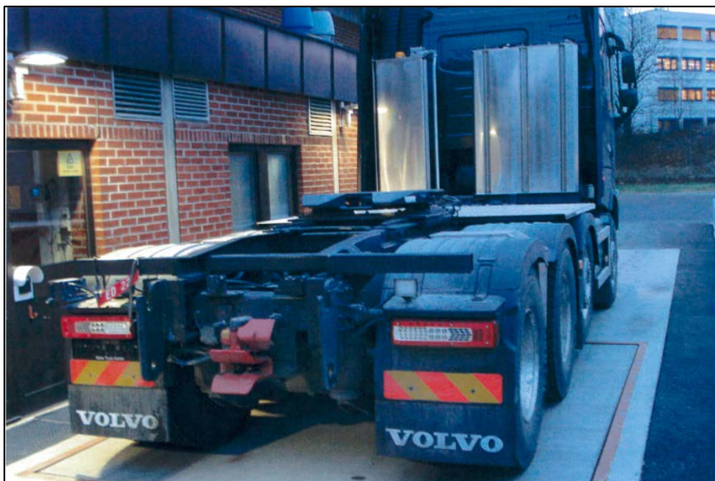
Figur 11: Lastebilen ved førstegangsgodkjenning med hydraulikk- og dieseltank bak førerhytten. Lastebilen var også godkjent med dumperkasse med tipp. Foto: Statens vegvesen
