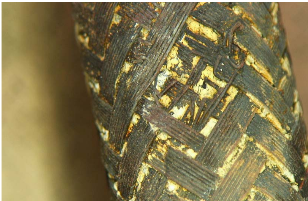
Figur 8: Mikroskopbilde av slitasjeskade på trykkslangen. Foto: Kripos
