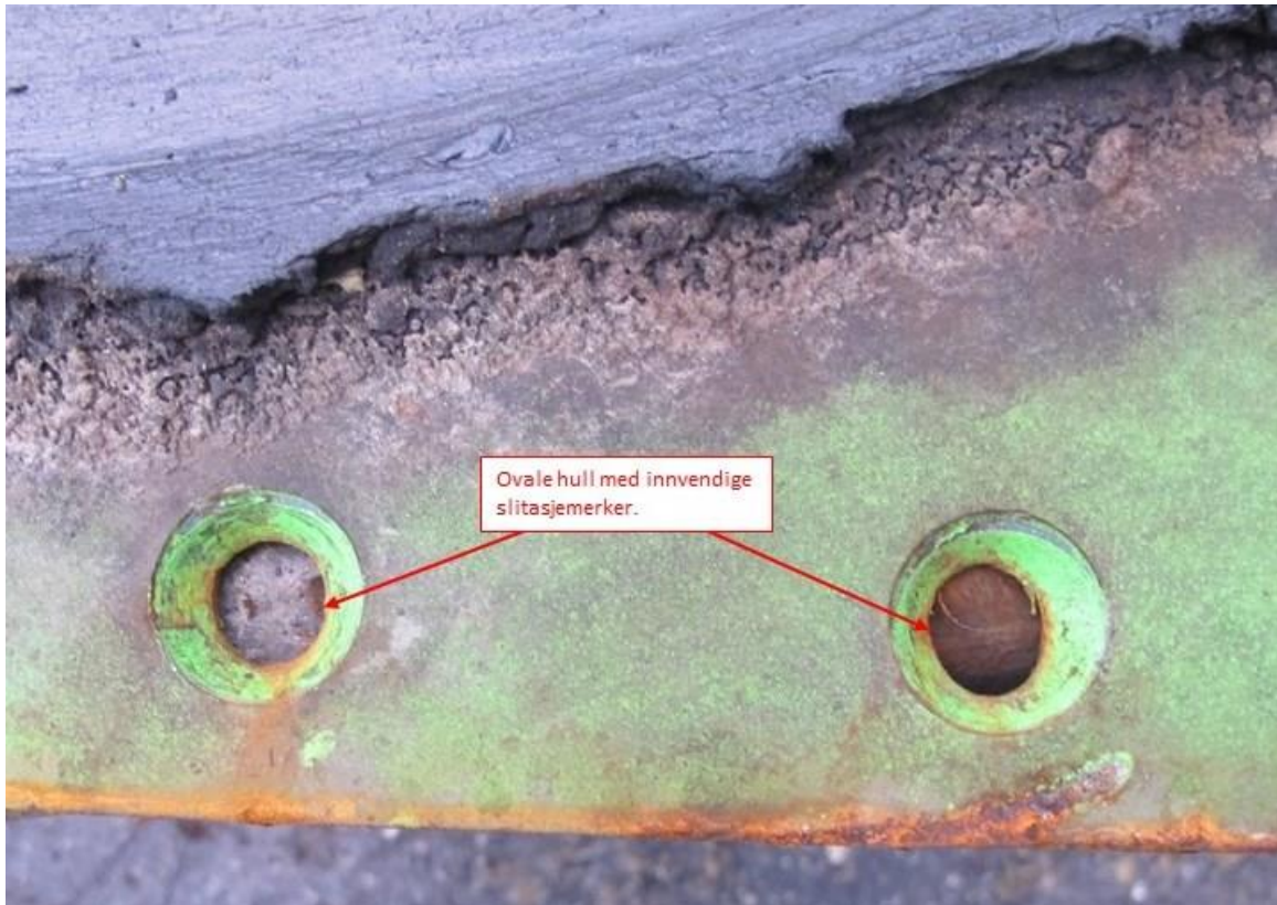
Figur 6: Slitasjemerker i bolthull i kingpinplate. Foto: SHT
