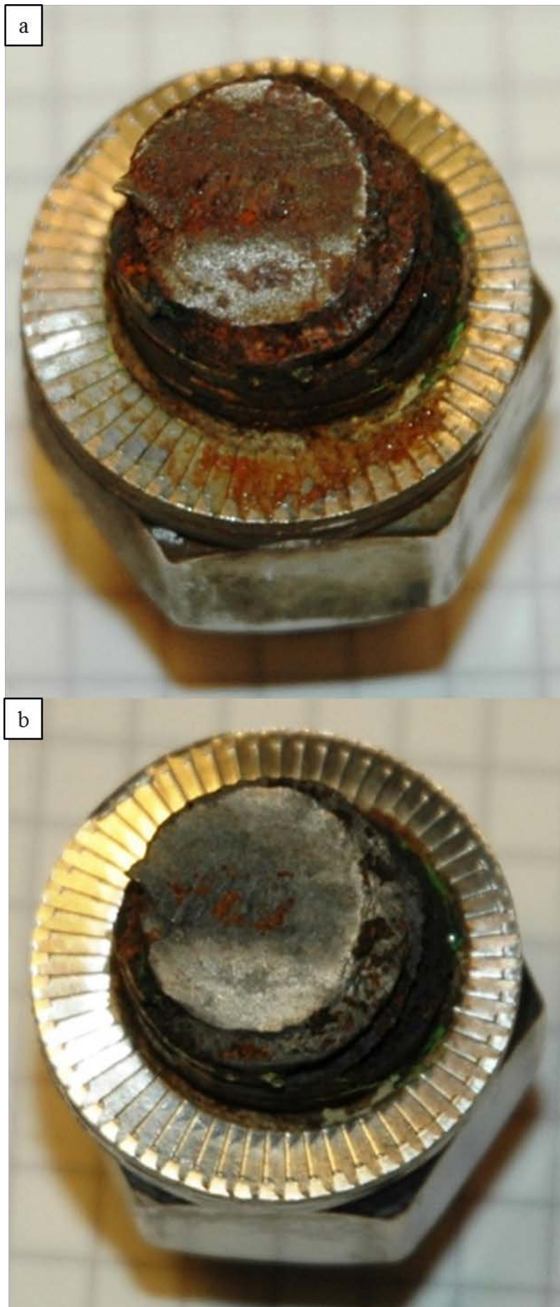
Figur 9 a: Bilde av bruddflate til bolt 3 som mottatt. b: Bilde av bruddflate til bolt 3 etter fjerning av korrosjon.
