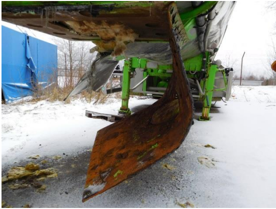
Figur 3: Den delvis avrevne kingpinplaten sett forfra. Foto: Statens vegvesen
