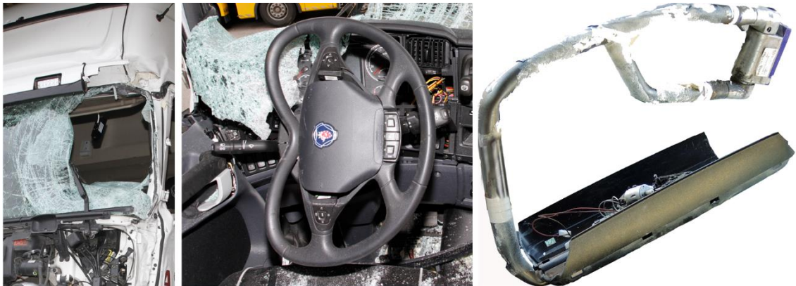
Figur 3: Frontrute der bussens sidespeil trengte inn, synlig deformasjon på lastebilens ratt og bussens sidespeil funnet på passasjersiden. Foto: SHT
