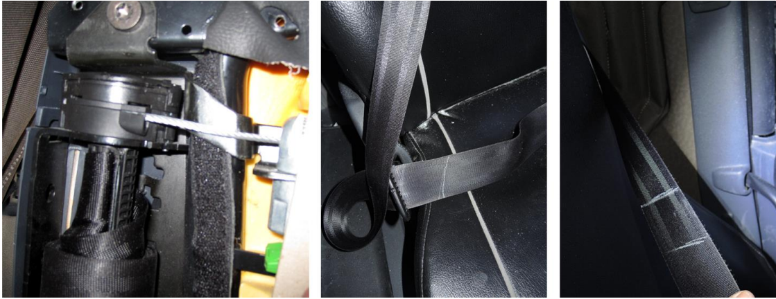
Figur 2: Undersøkelse av utløst bilbeltestrammer og strekkmerker på bilbeltet. Foto: SHT
