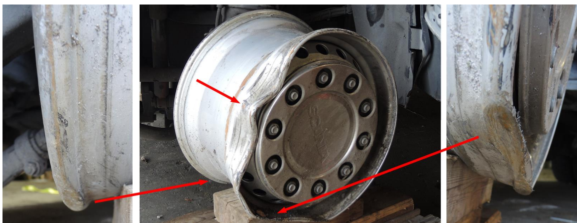
Figur 7: Deformasjoner på venstre framhjul og felg etter støt og skraping. Foto: SHT
