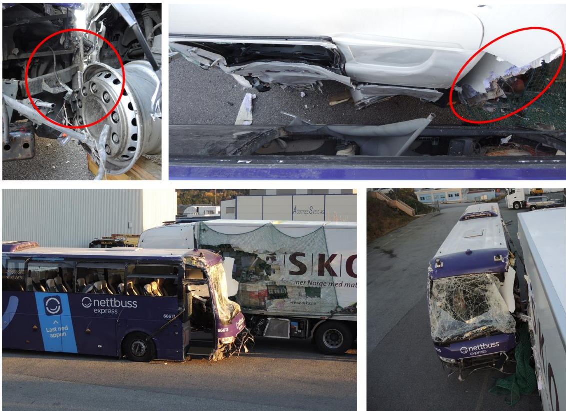
Figur 14: Rekonstruksjon av treffpunkt mellom kjøretøyene. Foto: SHT
